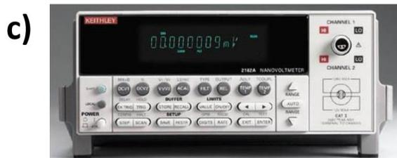
**Figura 2-9.** Vista frontal (a) del electrómetro para medición de altas resistencias a dos puntas (Keithley 6517B), (b) de la fuente de corriente de alta precisión (Keithley 6221) y (c) del nanovoltímetro Keithley 2182A. Estos últimos (b y c) se utilizan en conjunto para la medición a cuatro puntas de muestras con baja resistencia eléctrica.
