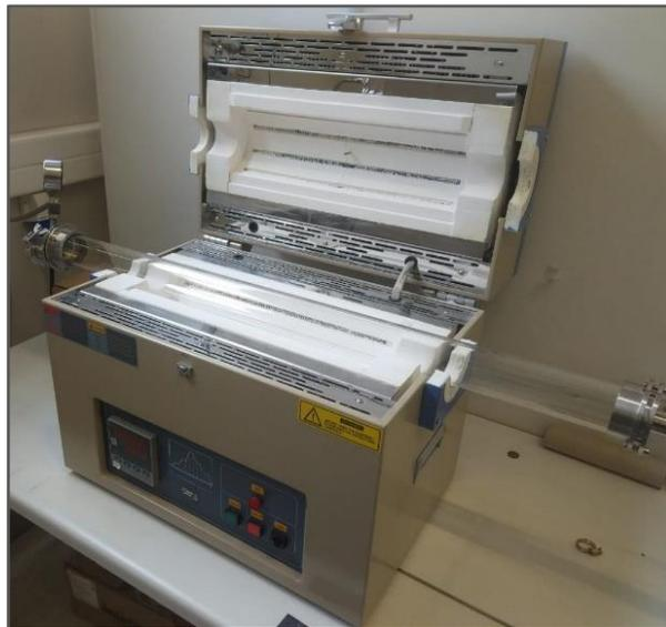
**Figura 2-4:** Horno tubular MTI, modelo OTF 1200X, donde se realiza el proceso CVD (sobre 600 °C) para el crecimiento de CNTs dentro de las plantillas de alúmina nanoporosa.
