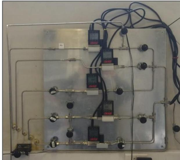
**Figura 2-5:** Sistema controlador de flujos de gases hecho en laboratorio. Basado en controladores marca Alicat, modelo MC500. Permite la elaboración de mezclas de gases con concentración y flujo determinado para el depósito CVD. Cuenta con control manual y remoto a través de un software programado en laboratorio.
