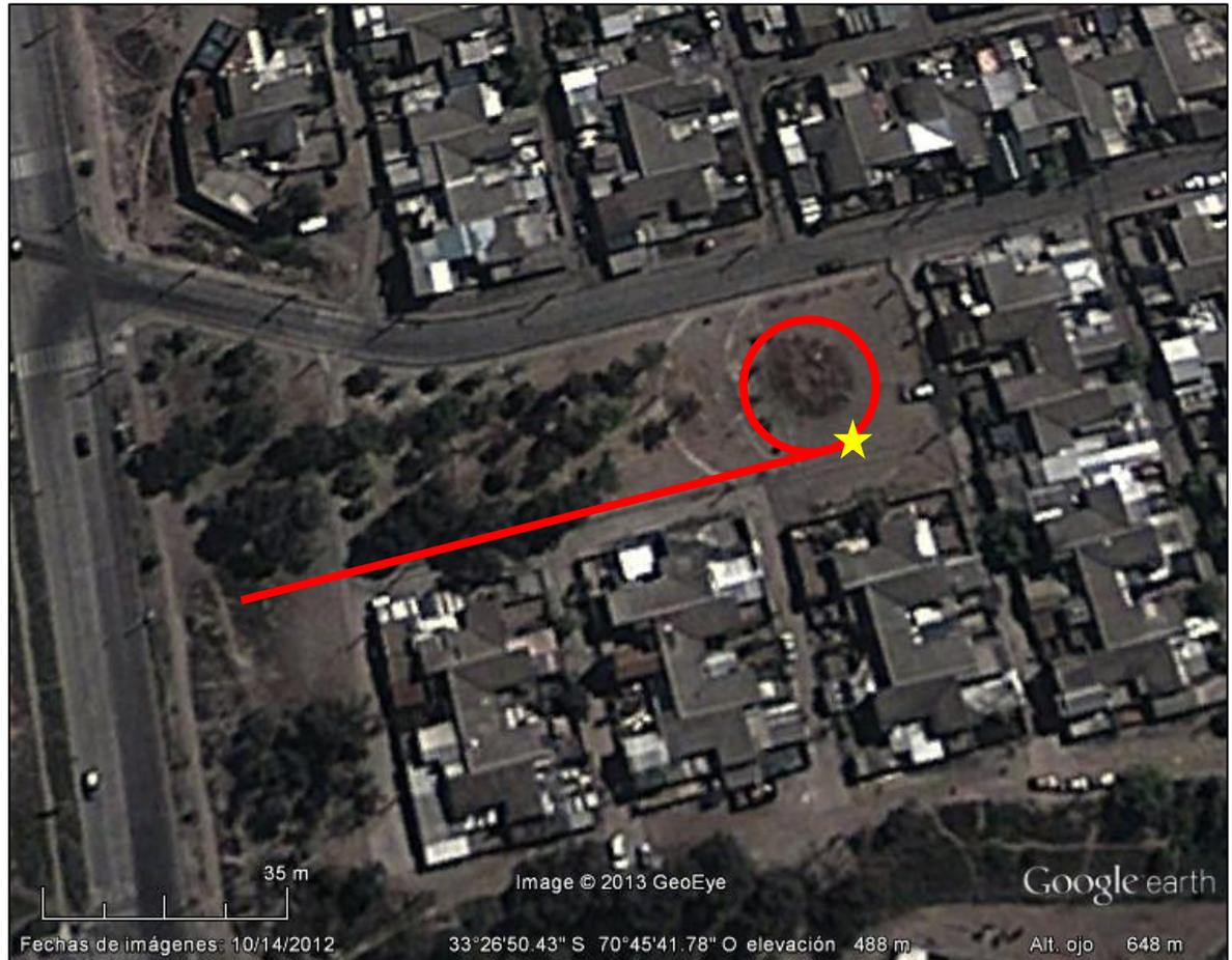
Figura B.4: Arreglos de geófonos utilizados en el sitio de estudio para el caso 2
