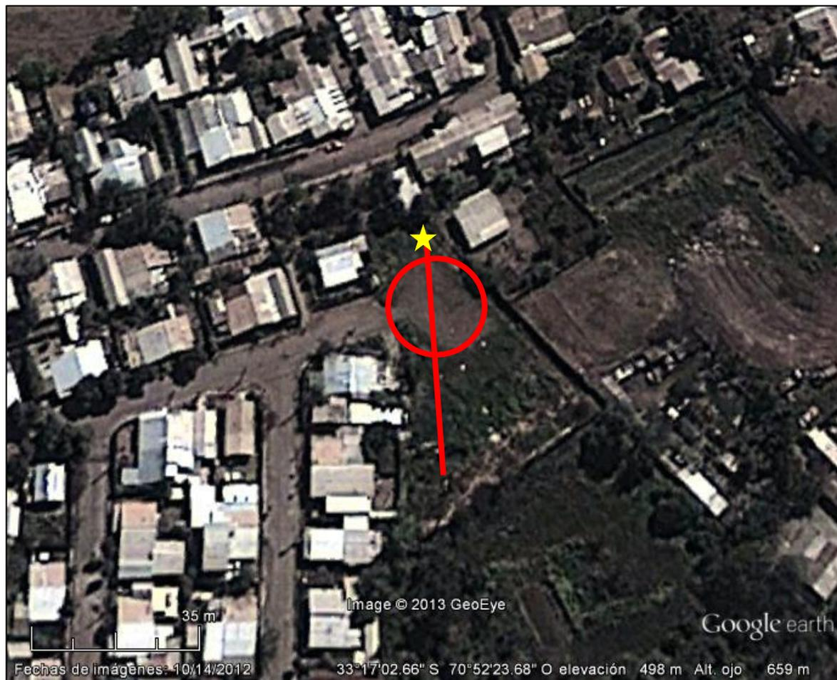
Figura B.6: Arreglos de geófonos utilizados en el sitio de estudio para el caso 3
