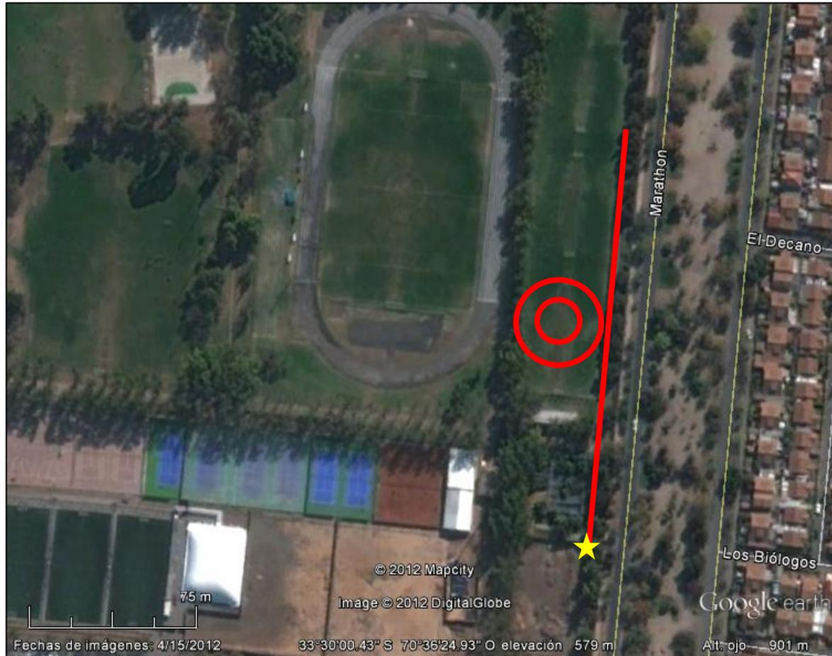
Figura B.2: Arreglos de geófonos utilizados en el sitio de estudio para el caso 1
