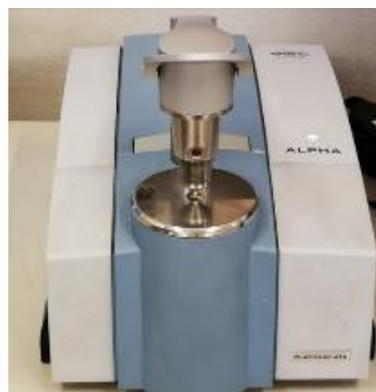
Figura 21. Espectrofotómetro Bruker ALPHA serie FT-IR, para la espectroscopía de la película de las bayas y las láminas foliares.
