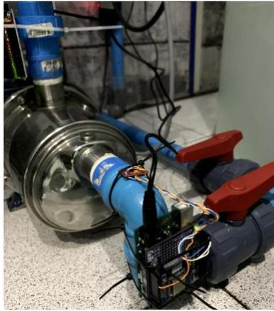
Figura 1-1: MVP1 - Motobomba 125 litros/min - 2,3 bar acero inoxidable
