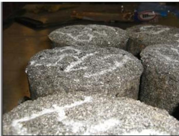
Esta reacción química debe ser estudiada con mayor detalle, en futuras investigaciones para poder controlar su efecto y de esta manera evitar que afecte el comportamiento mecánico de las mezclas. En un principio se plantean como medidas de control realizar un tratamiento previo de las cenizas para reducir su contenido de sulfatos, o restringir el contenido máximo de ceniza a agregar.
