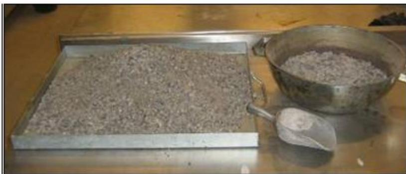
Figura 3-5. Muestra de emulsión asfáltica y agua
