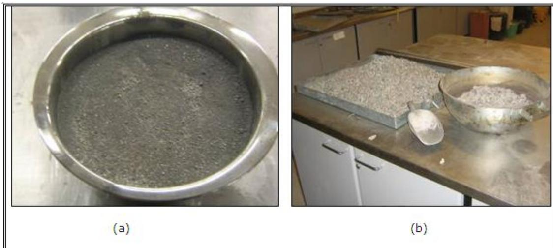
Figura A-2. (a) Emulsión asfáltica y agua, (b) emulsión asfáltica diluida en agua
