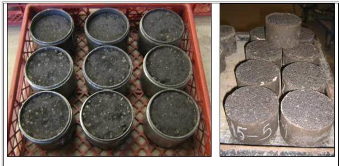
Figura A-7. (a) Molde compactador giratorio, (b) Probeta de compactador giratorio.
