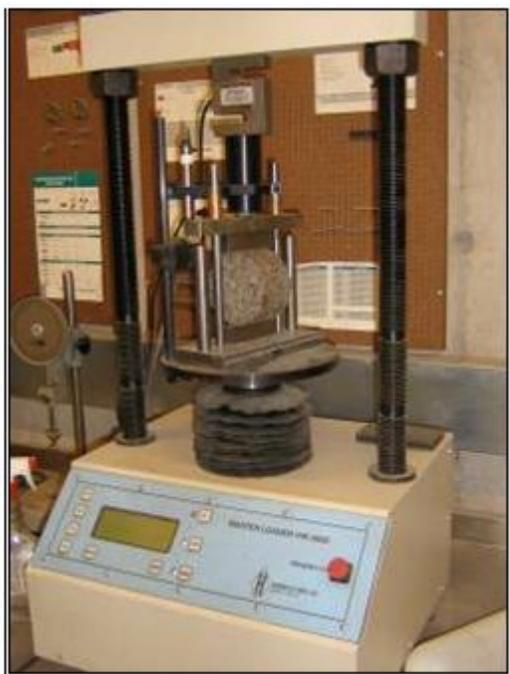
La ejecución del ensayo se rige por la norma AASHTO T283-89 (*Resistance of compacted bituminous mixture to moisture-induced damage*), en la sección 10
