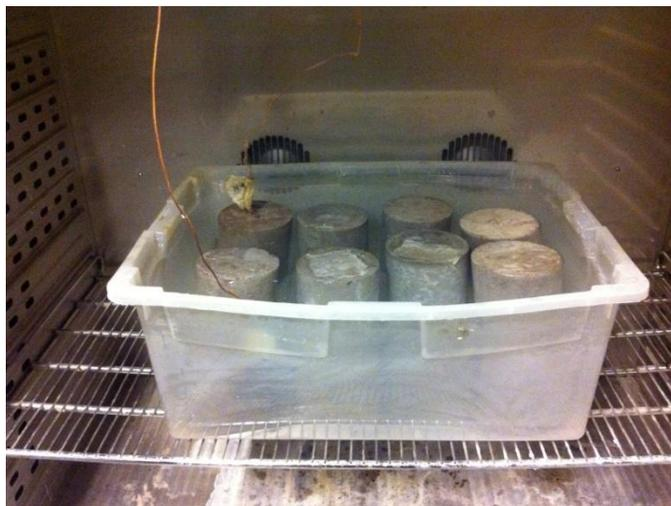
Figura 59: Hormigón en piscinas sometidos a ciclos térmicos simulando hormigones masivos.
