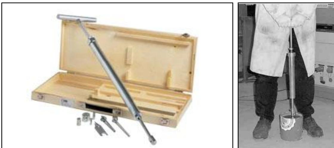
Figura 42: (a) Equipamiento para medición de tiempos de fraguado (a) y (b) método de ensayo (Fuente: Pinto y Hover (1999)).
