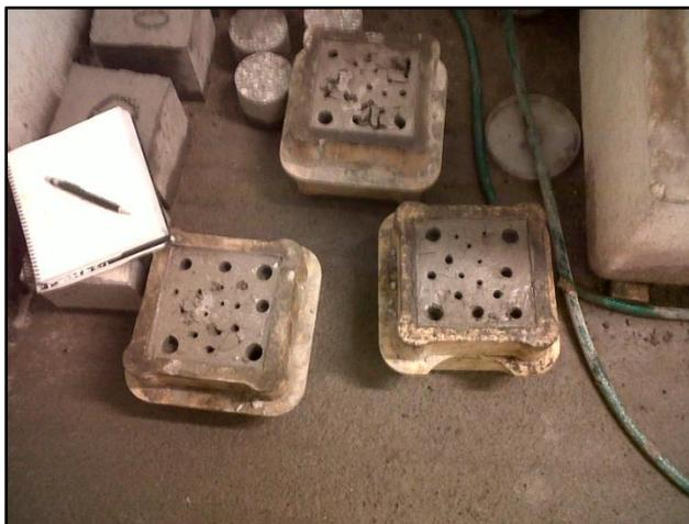
Figura 44: Cubos de mortero de hormigón utilizados para medir el tiempo de fraguado.
