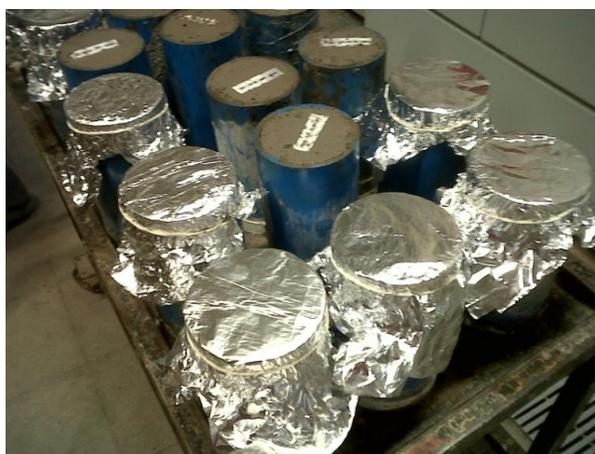
Figura 58: Probetas cilíndricas antes de ser sometidas a ciclos térmicos.
