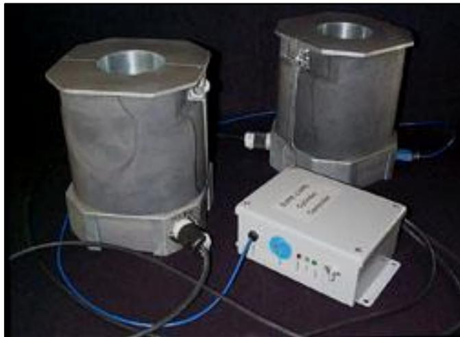
Figura 12: Parte del equipamiento desarrollado para realizar *match curing* en probetas de hormigón (Fuente: [www.concret curing.com](http://www.concret curing.com)).
