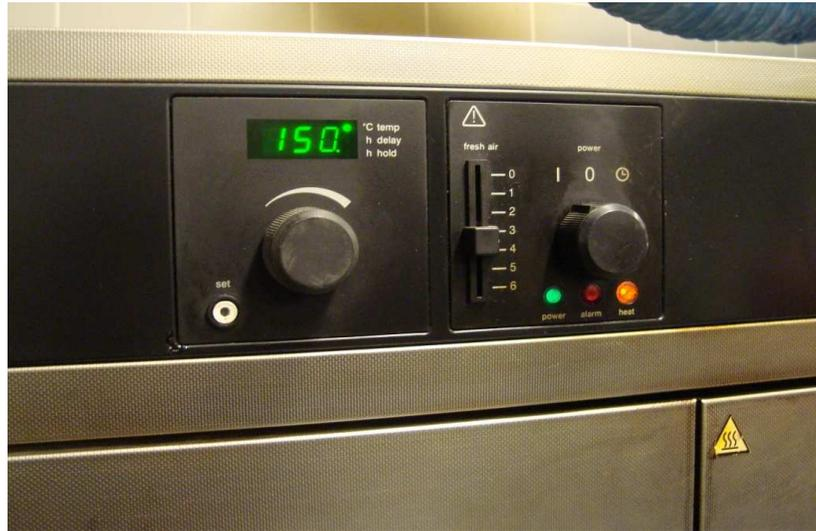
Imagen 13: Horno para acondicionamiento de muestras para ensayo DSR.
