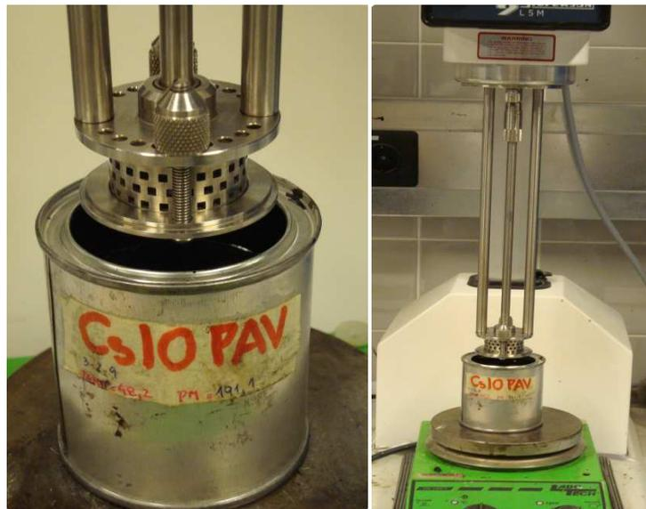
Imagen 14: Proceso de homogenización de muestras de LA para ensayo DSR.
