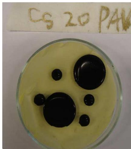
Imagen 16: Probetas de 8 y 25 mm durante almacenamiento previo ensayo DSR.
