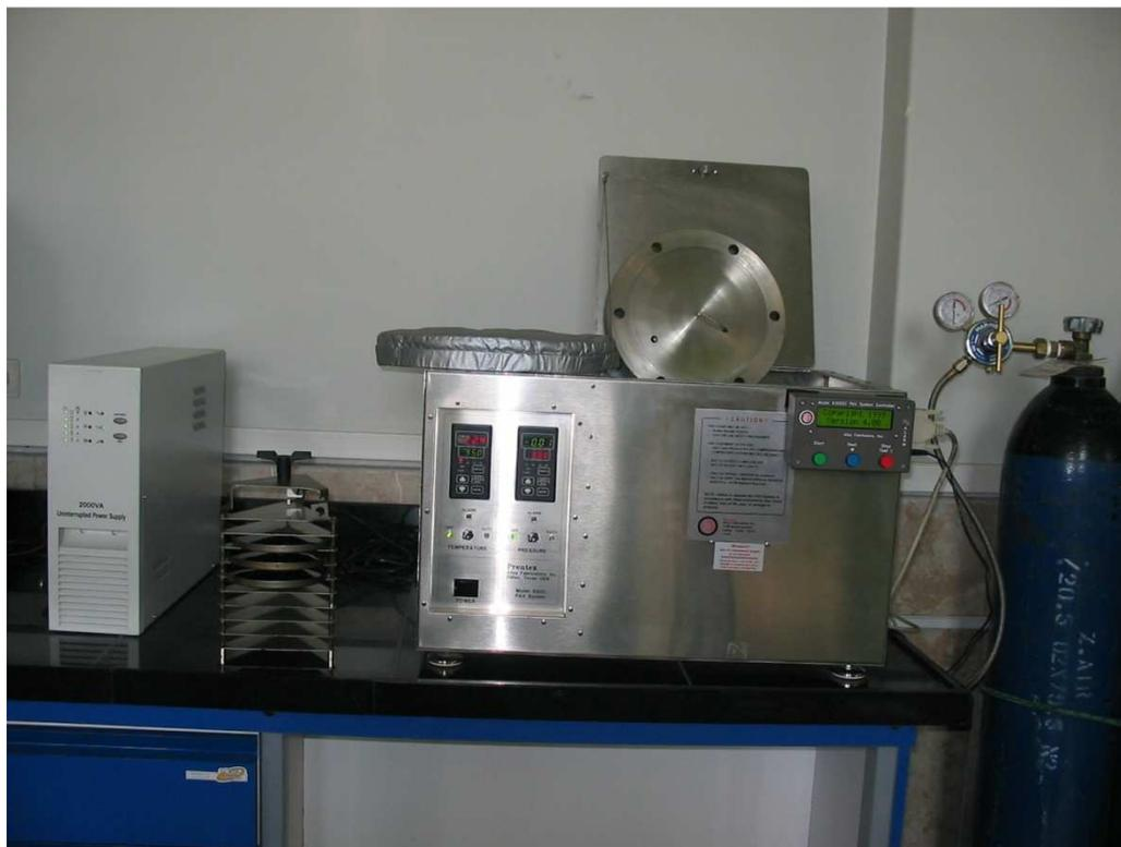
Imagen 10: Cámara presurizada para realizar ensayo PAV.
