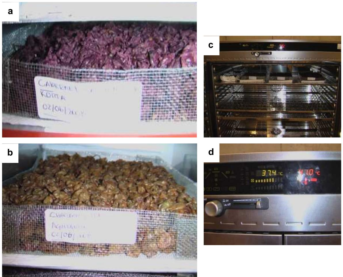
Imagen 3: Proceso de deshidratación del orujo a) Bandeja de secado muestra orujo proveniente de cepa Cabernet Sauvignon, b) Bandeja de secado muestra de orujo proveniente de cepa Chardonnay, c) Disposición de vendejas de secado en horno con ventilación forzada., d) Panel de control de temperatura de secado ( $40^{\circ}\text{C} \pm 2^{\circ}\text{C}$ )
