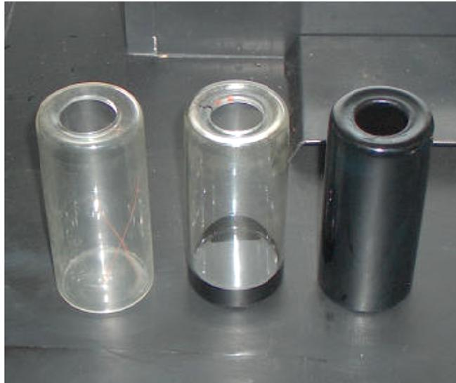
Imagen 8: Contenedores para ensayo de envejecimiento en película delgada en horno rotatorio, contenedor vacío, contenedor con muestra previo ensayo, contenedor post ensayo.
