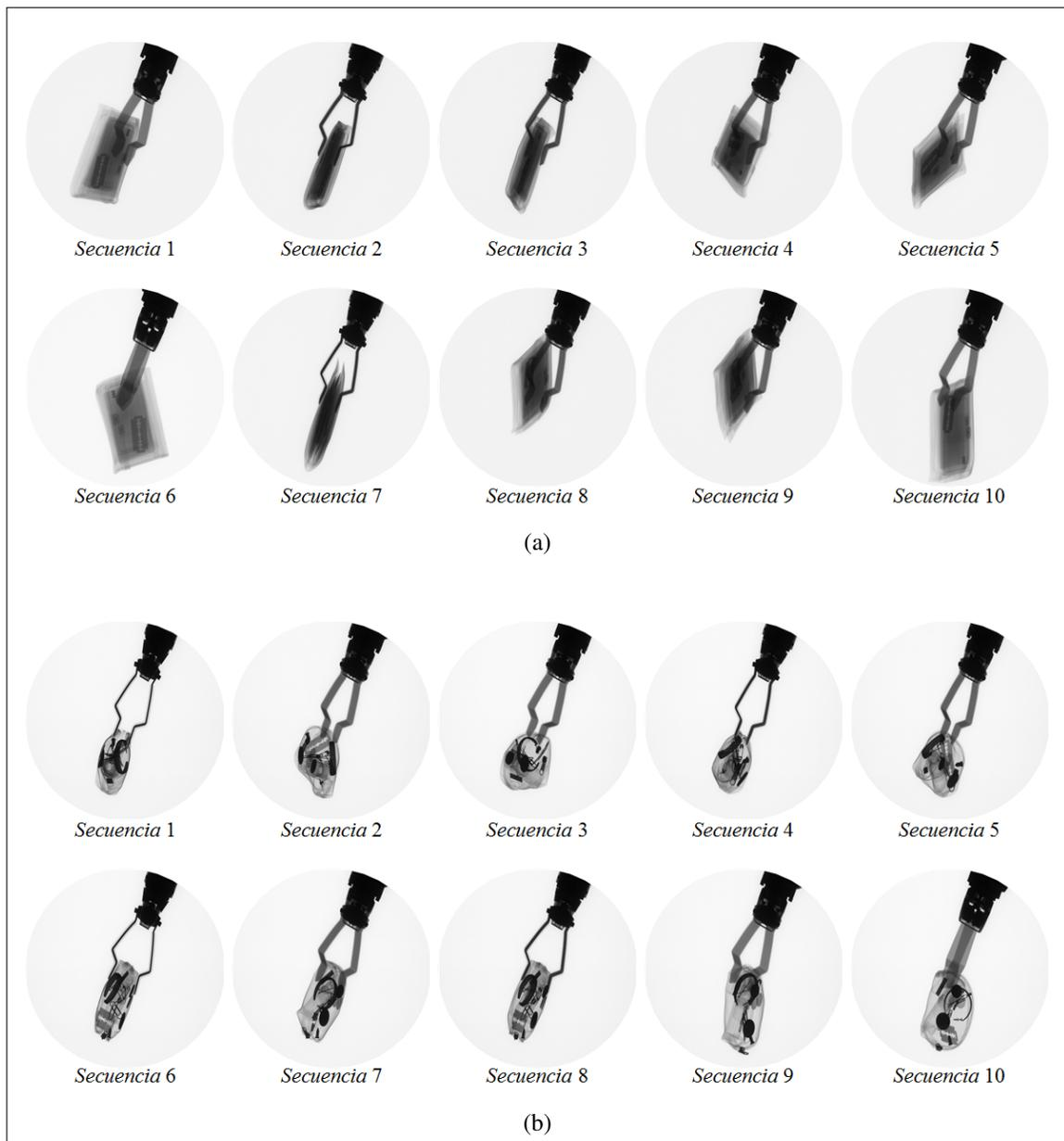
Figura D.1. Primera imagen adquirida para cada secuencia de inspección, usando sistema automático de sujeción y rotación, a) Inspección de objeto *Obj1*, y b) Inspección de objeto *Obj3*.
