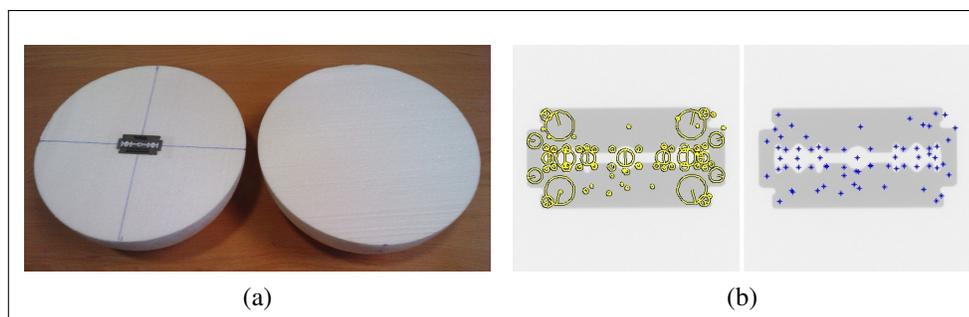
Figura 5.6. Caracterización de una hoja de afeitar; (a) Esfera de EPS para la caracterización, y (b) Hoja de afeitar con dos formas de representación de los descriptores SIFT: magnitud-orientación y *keypoints*.
