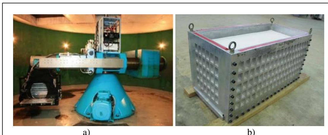
**Figura 2. 11 .** Ensayos de centrífugas LEAP-UCD-2017 en NCU: a) Centrífuga geotécnica en CNU b) Contenedor laminar de longitud 767 mm, ancho de 355 mm, alto de 400 mm y peso neto de caja vacía de 106,8 kg Kutter and Manzari (2020).
