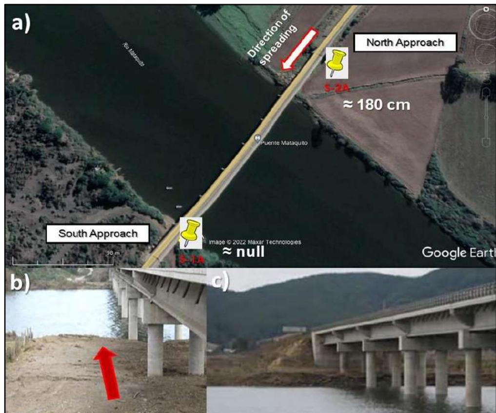
**Figura 5. 8** Desplazamiento lateral en puente Mataquito (a) Google Earth® del puente Mataquito y dirección del desplazamiento lateral en el estribo norte (b) Desplazamiento lateral hacia el río, estribo norte del puente (c) Desplazamiento lateral en el extremo norte del puente (Bray y Frost, 2010)
