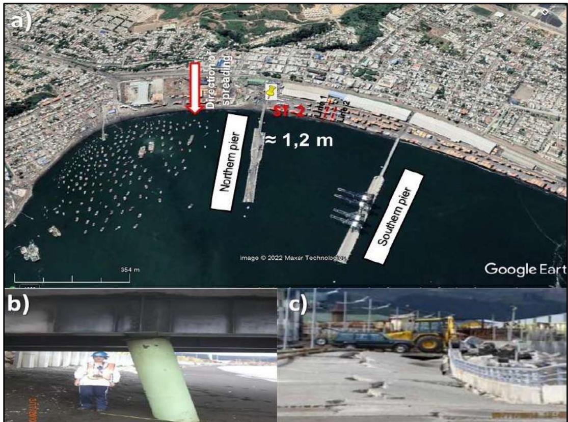
**Figura 5. 14** Desplazamiento lateral en el Puerto de Coronel (a) Ubicación de la línea de medición del desplazamiento lateral en el pilar de soporte en el Puerto de Coronel (b) Rotación del pilar en Puerto de Coronel debido al desplazamiento lateral (c) Desplazamiento lateral reflejado en el pavimento destruido y pared agrietada (Bray et al. 2010)
