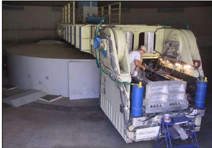
**Figura 3. 4** Aparato de centrífuga y contenedor de caja laminar (Boulanger, 2009)
