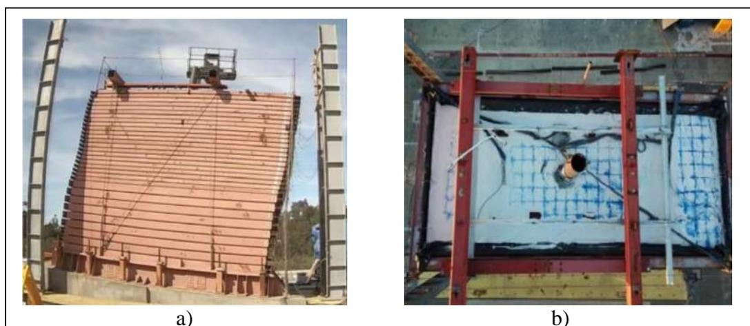
**Figura 2. 12 .** Ensayos de mesas vibratorias realizados en la Universidad de San Diego para estudiar el desplazamiento lateral a) Mesa vibratoria para estudiar el desplazamiento lateral en pendiente suave b) Vista en planta del ensayo donde se aprecian las distorsiones causadas por el sismo.
