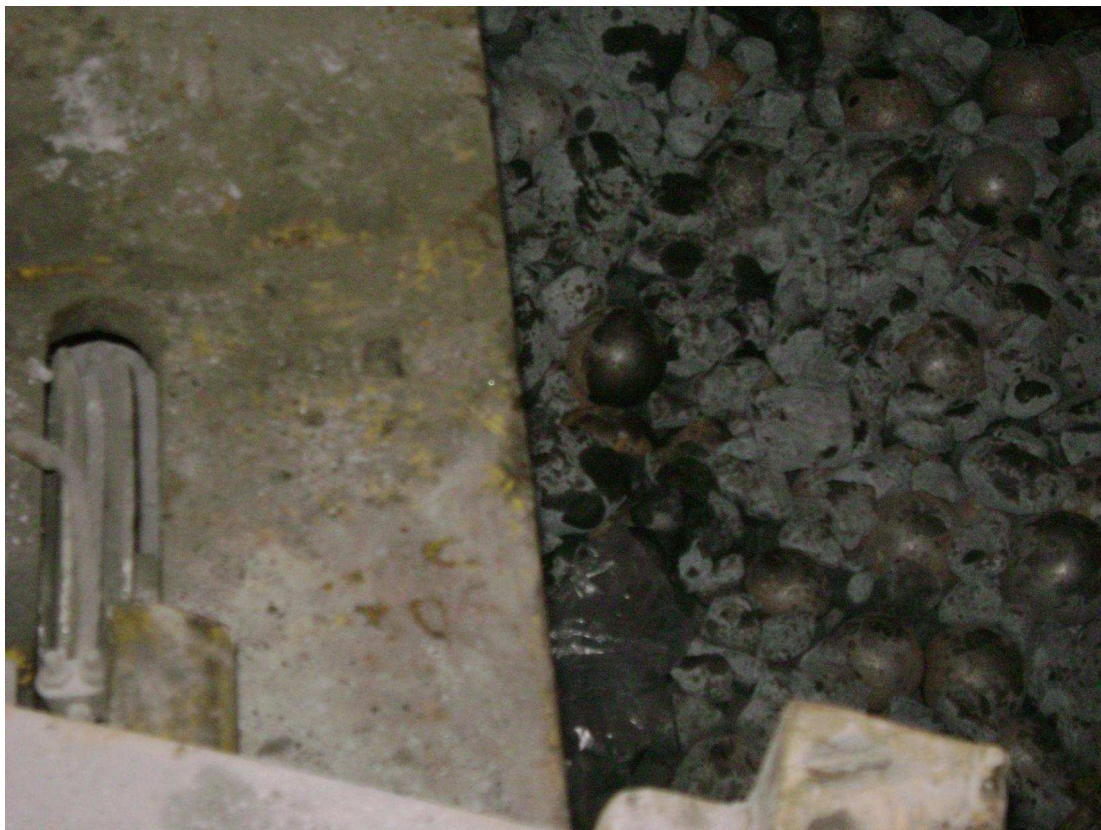
FIGURA B.3. Bolas de acero y piedras al interior del molino SAG
