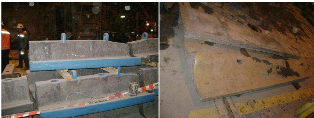
FIGURA C.1. Revestimientos nuevos vs revestimientos usados
