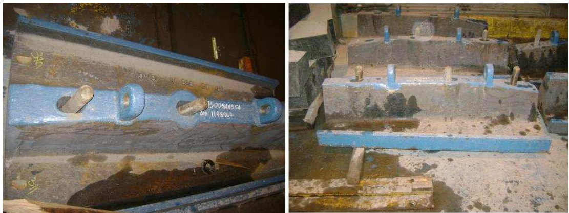
FIGURA C.2. Revestimientos con los pernos
