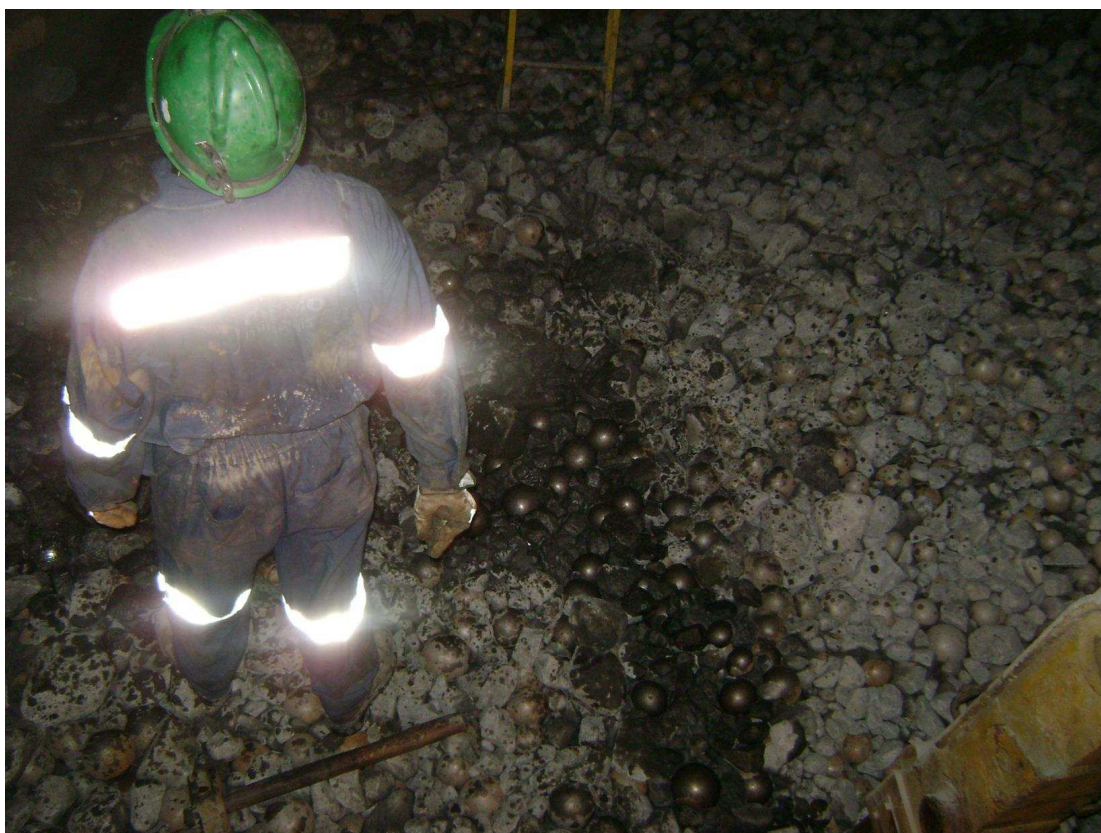
FIGURA B.2. Material existente al interior del molino SAG
