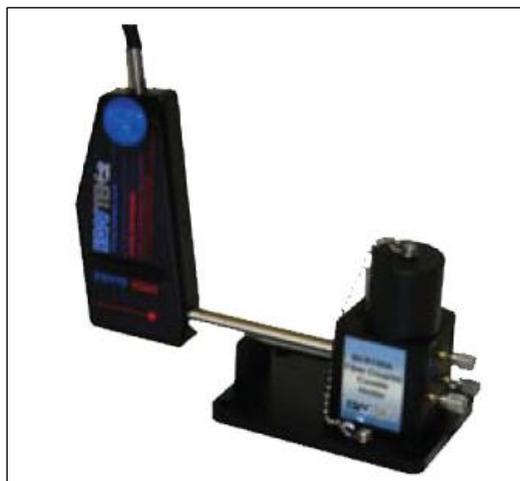
Figura 2.7: Sostenedor de cubeta utilizado
