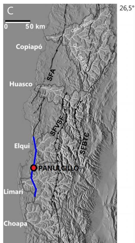
Figura 1 - 12. Trazas del Sistema de Fallas de Atacama (SFA), cuyo segmento sur (en azul) corresponde a la Falla Romeral definida por Emparán y Pineda (2006). Fuente: modificado de Aguilar et al, 2013
