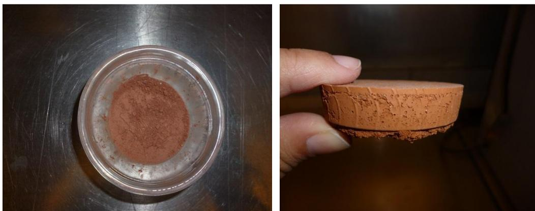
**Figura 6-3.** Consolidación lograda en ladrillo pulverizado con consolidante Wacker OH 100
