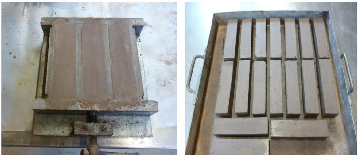
**Figura 6-8.** Detalle de moldes utilizados y especímenes moldeadas
