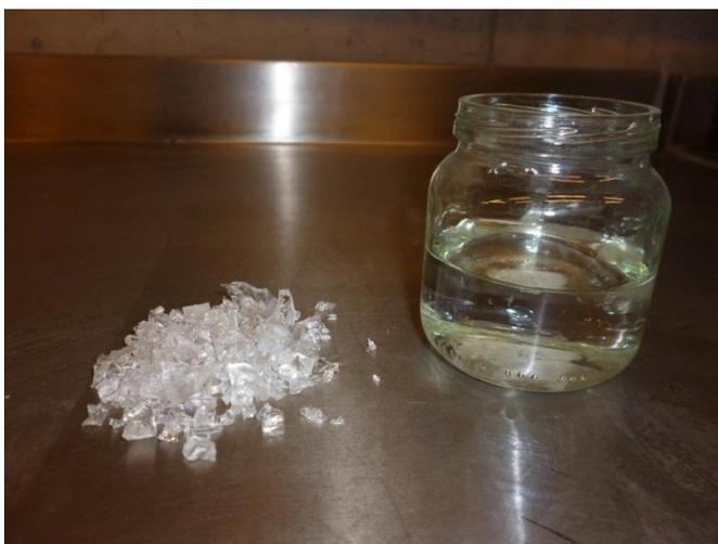
**Figura 6-2.** Consolidante Wacker OH 100 derecha, sílice amorfo precipitado izquierda.
