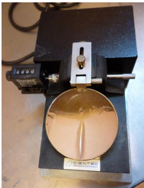
**Figura 6-6.** Detalle de cuchara de Casagrande para determinación Límites de Atterberg
