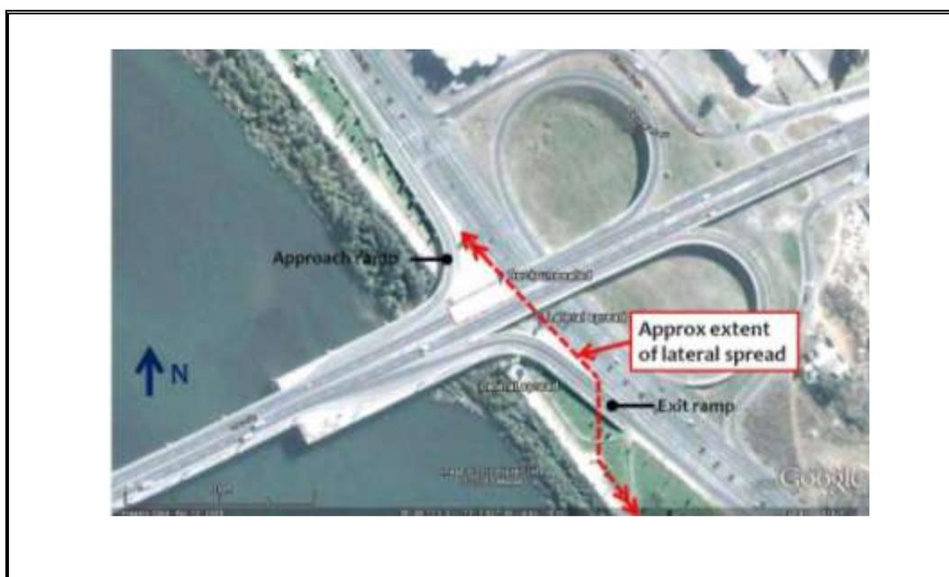
Figura 3-7: Vista en planta de los daños en los accesos al estribo norte de Llacolén.
