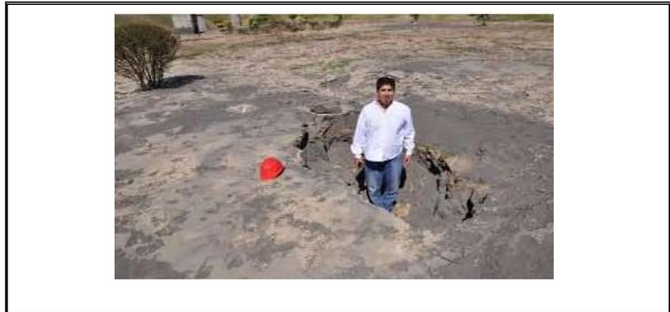
Figura 3-5: Eyección de arena en las cercanías de la aproximación del estribo norte.
