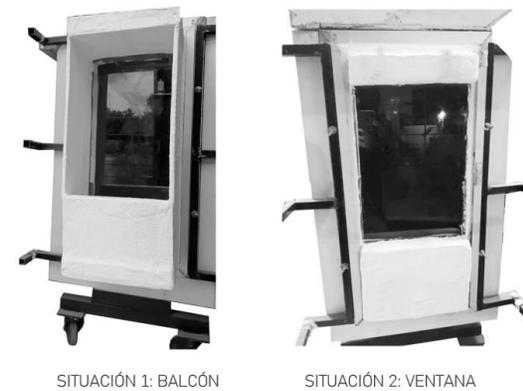
Fig. 72. Fragmentos de la Fachada construidos y puestos en el marco de la caja que aísla del exterior. Fuente: Elaboración propia.
