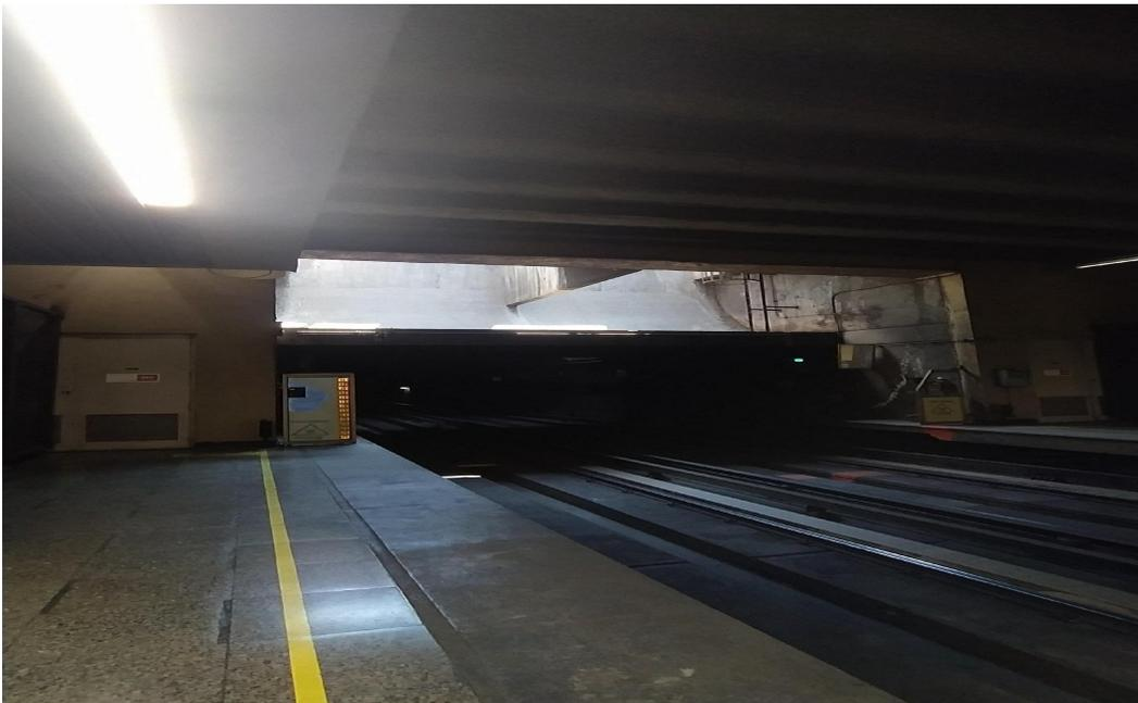
Figura 10-1: Boca de túnel de estación de metro República. La presencia del pozo de compensación justo encima de la boca del túnel, anula casi por completo el efecto pistón tanto en la llegada o salida de un tren de la estación.
