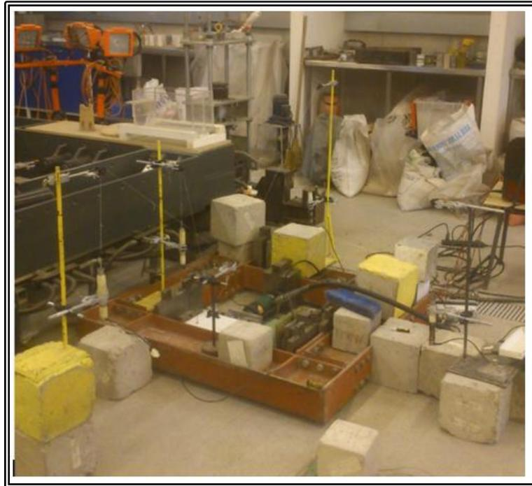
Figura 6.4 Deposición general de ensayo, marco de carga, transductores de desplazamiento y equipo de toma de datos
