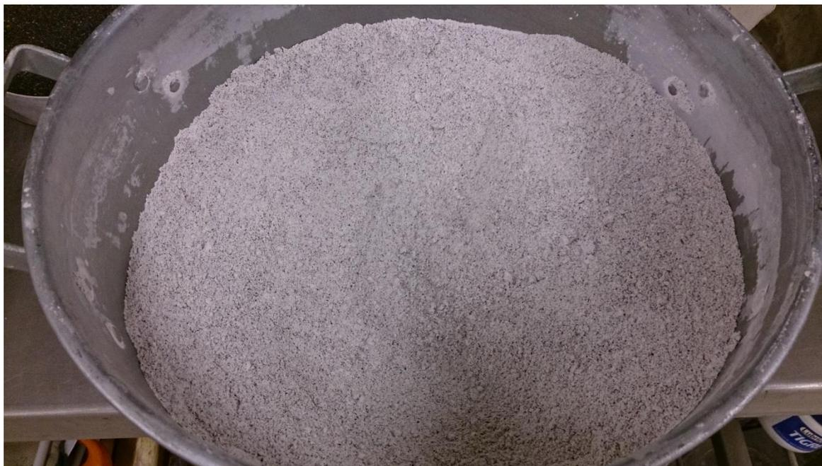
Figura A.3 Mezclar yeso y arena hasta conseguir una mezcla uniforme.
