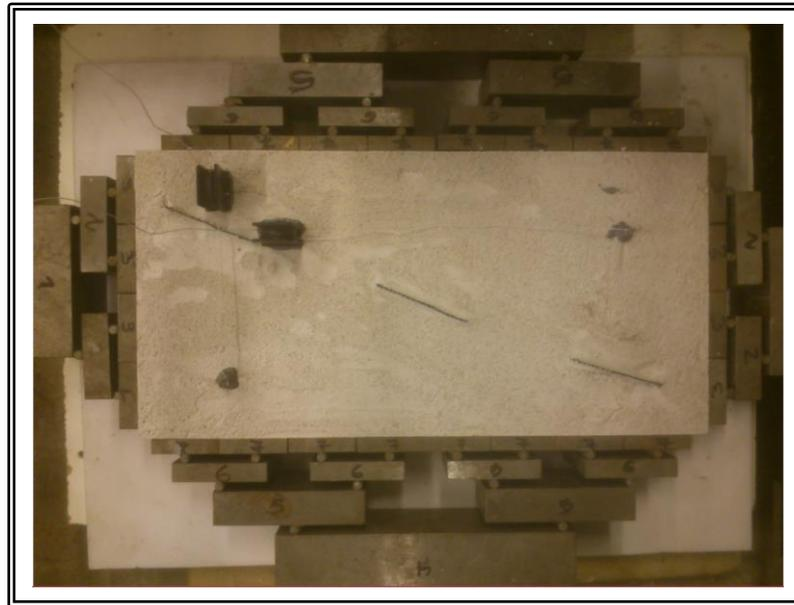
Figura 6.3 Detalle montaje de probeta con placa de carga y 2 poleas.
