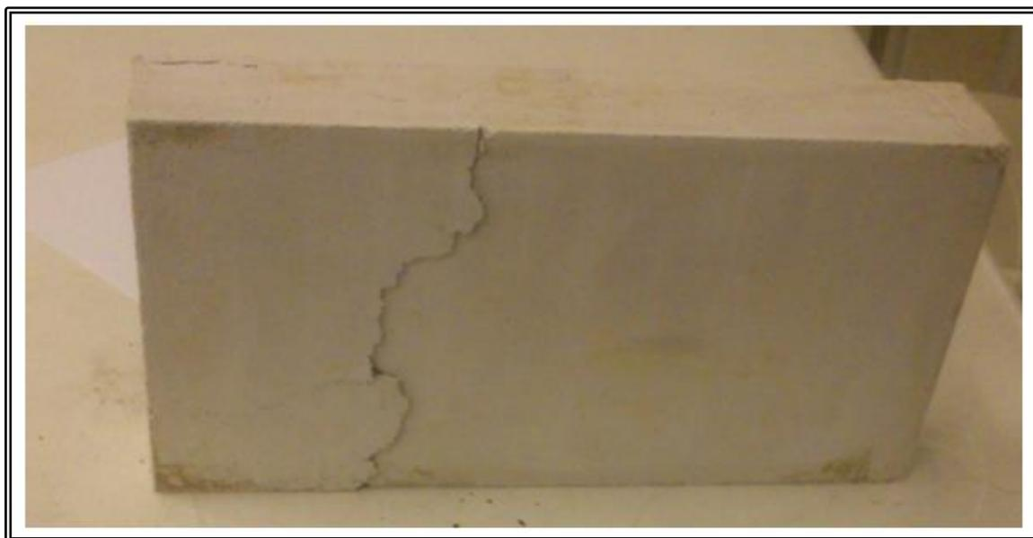
Figura 6.10 Vista inferior modo de falla de probetas de material intacto sometidas a compresión biaxial.
