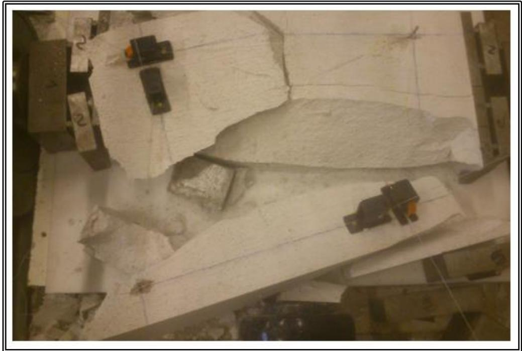
Figura 6.5 Ejemplo falla ensayo biaxial sin confinamiento en probeta de material intacto.
