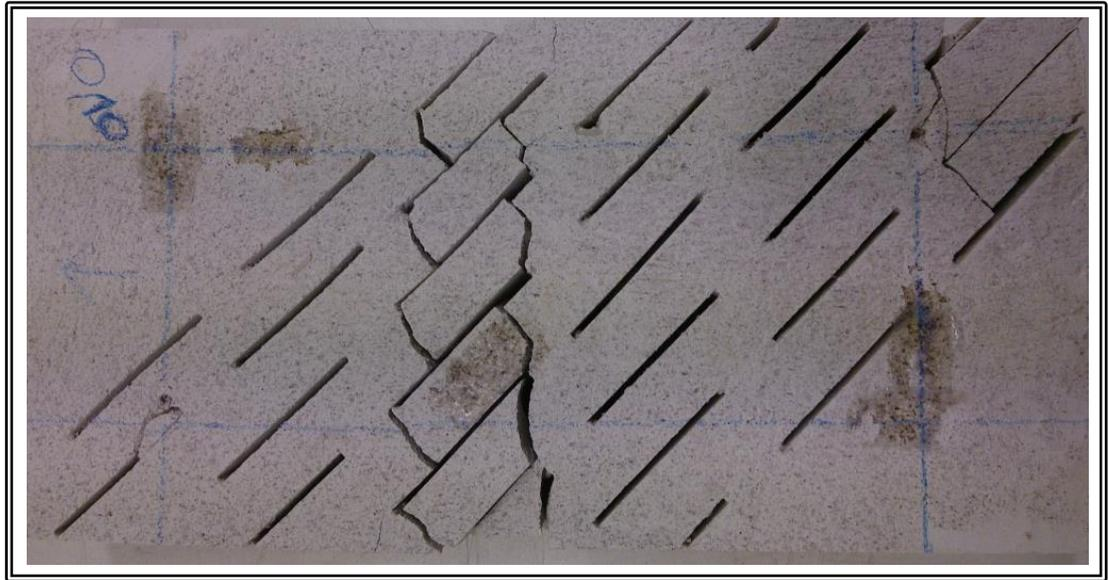
Figura 8.16 Ejemplo de falla en probetas con un conjunto de estructuras abiertas con geometría 2.
