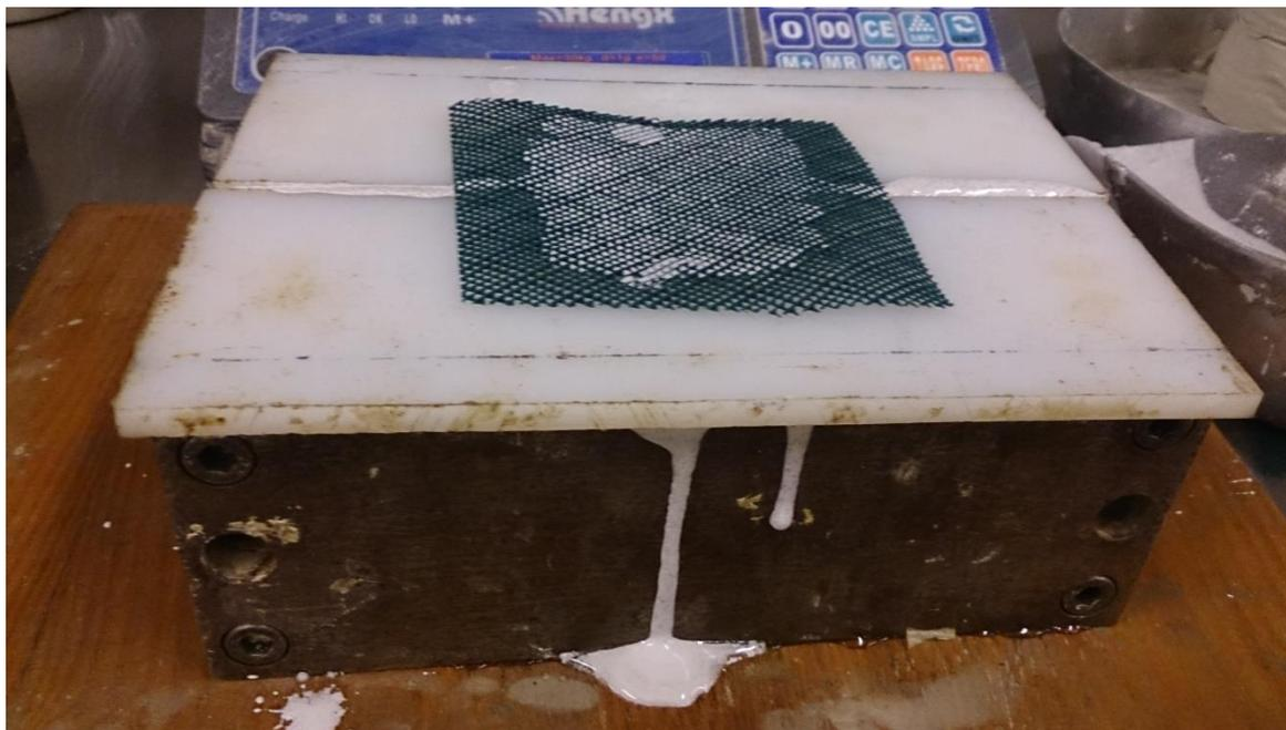
Figura A.7 Vista lateral del moldaje con separador inferior y malla.
