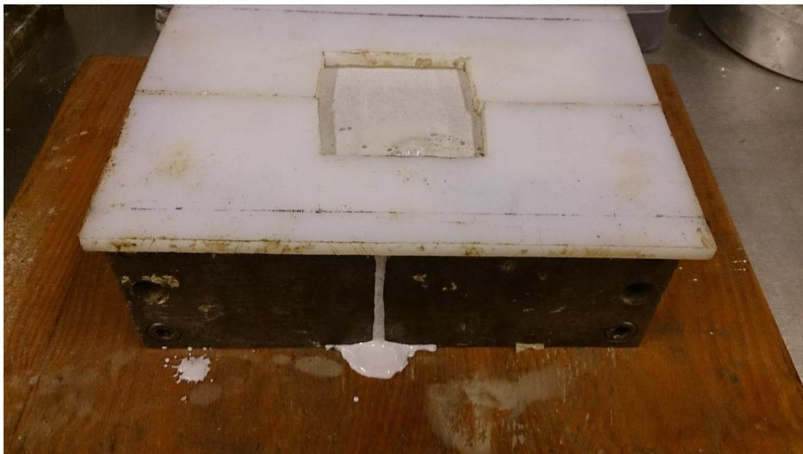
Figura A.5 Se llena parte inferior del moldaje y se colocan los separadores inferiores.
