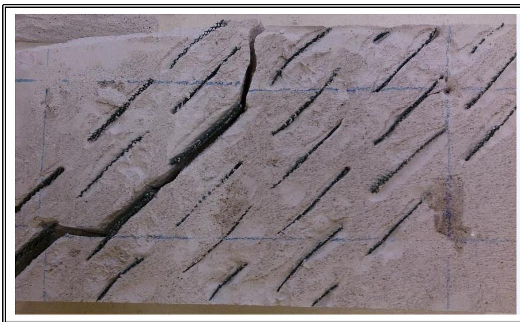
Figura 8.19 Ejemplo de falla típico en probetas con un conjunto de estructuras cerradas correspondientes a la geometría 2.
