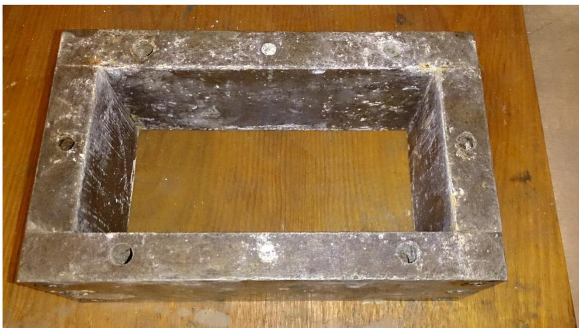
Figura A.4 Se colocan moldajes sobre superficie plana.
