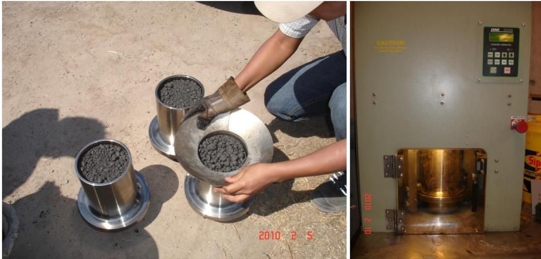
**Fotografía 11.-** Viernes 05-02-2010. Toma de muestra en campo (probeta superpave) de mezcla de emulsión asfáltica. Miércoles 10-02-2010. Elaboración de probeta Superpave mediante compactador giratorio (SGC) con presión 650 KPa 100 vueltas a velocidad de 30 giros/min.
