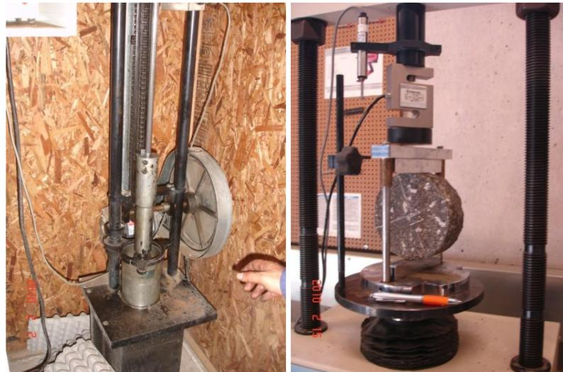
**Fotografía 12.-** Elaboración de probetas Marshall con diámetro de 4 pulg. mediante el compactador mecánico 75 golpes por cara de la probeta. Ensayo de Resistencia a la Tracción Indirecta (ITS) sobre probetas superpave con diámetro de 6 pulg.
