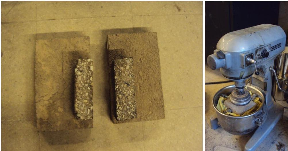
**Fotografía 18.-** Obtención de Paralelepípedos de mezcla asfáltica AE , para ensayo de resistencia a compresión. Ensayo de Resistencia al Desgaste Superficial de Bloques de Asfalto.
