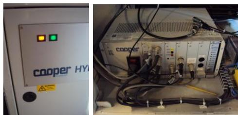
*Figura 7: Encendido de Equipo COOPER HYD25 y Chequeo de conexión de cable de LVDT y Celda de Carga.*
