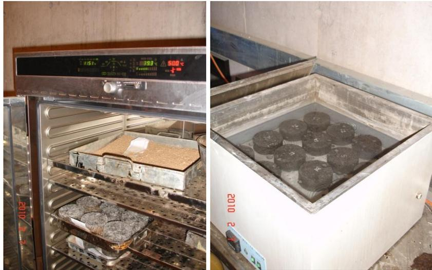
**Fotografía 13.-** Preparación y curado de la probetas para ensayos por un período de 72 horas a una temperatura de 40°C. Curado de muestras en condición saturada luego de curado en seco, por un período de 24 horas a 25°.
