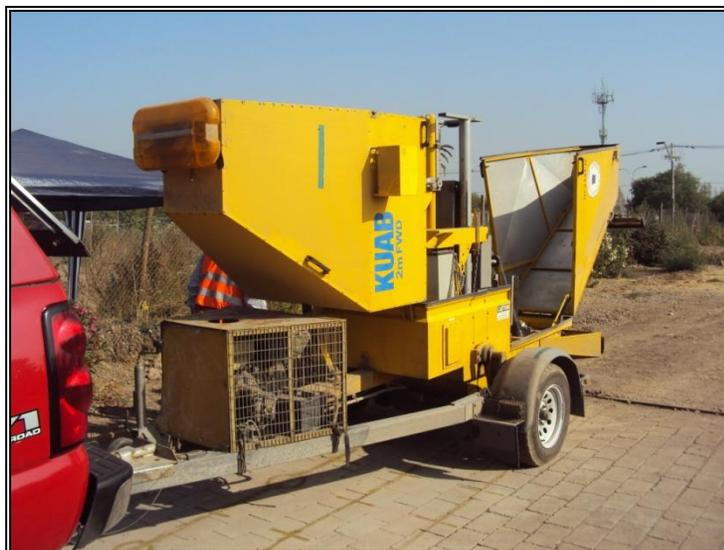
Figura 5-13: Ensayo de Deflectometría de Impacto FWD sobre Pavimento de Bloques de Asfalto.
