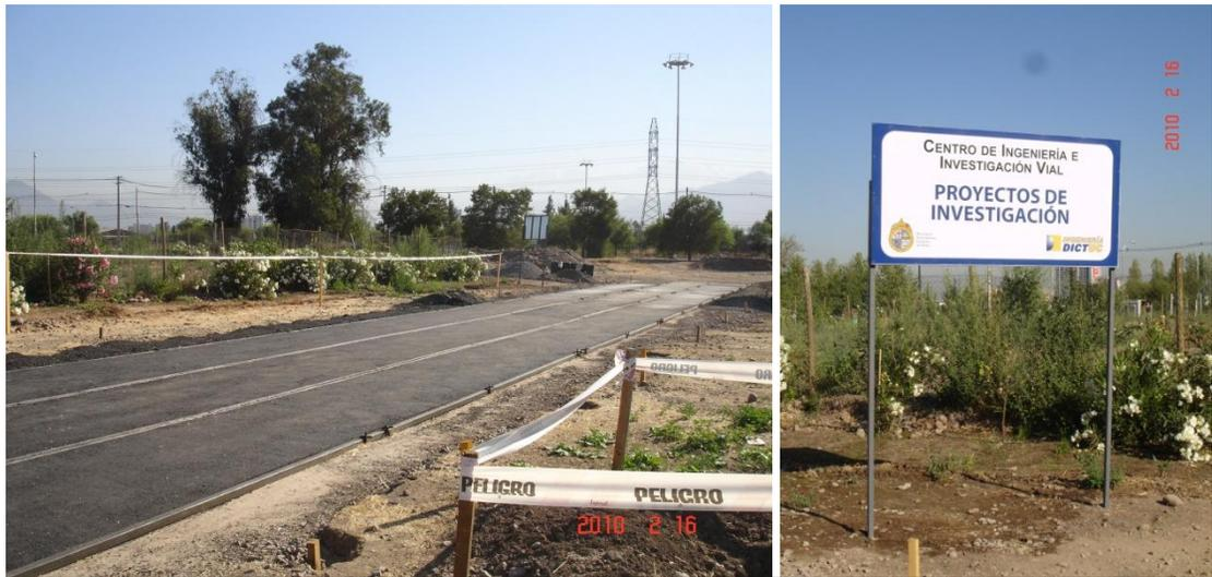
**Fotografía 15.-** Terminado final de tramo de prueba con dos superficies de rodadura: abs. 0+000 – 0+020 mezcla asfáltica en caliente; 0+020 – 0+040 mezcla de emulsión asfáltica utilizando ceniza FBC. Letrero de identificación de Proyecto en tramo de prueba en el campus San Joaquín de la PUC.
