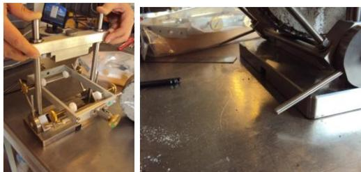
*Figura 4: Montaje de Ensayo y varilla de liberación del nivel de alineamiento.*
