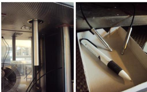
*Figura 6: Barra de Carga y LVDT.*
