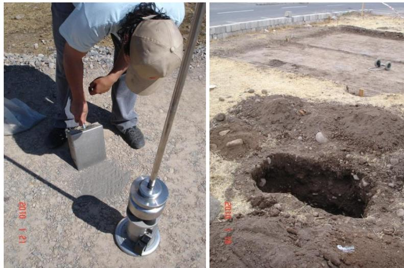
**Fotografía 4.-** Ensayo con equipo Prima 100- Deflectómetro de Impacto para determinar la resistencia del suelo a nivel de Sub-rasante, Base espesor 15 cm, Base espesor 30 cm a cada 2.5 m del abscisado y en lado derecho, eje, izquierdo de cada abscisa señalada. Lunes 18-01-2010. Excavación de calicata y toma de muestra sobre terreno adjunto al tramo de prueba para ensayos de mecánica de suelos.
