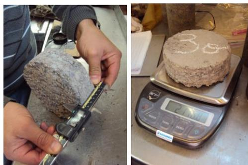
*Figura 2: Medida de espesor y peso de la probeta.*
