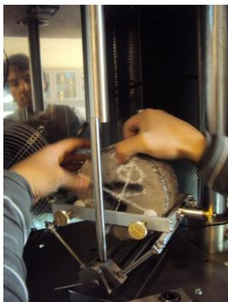
Figura 11: Giro  $90^\circ$  de la probeta para segunda parte de ensayo.
