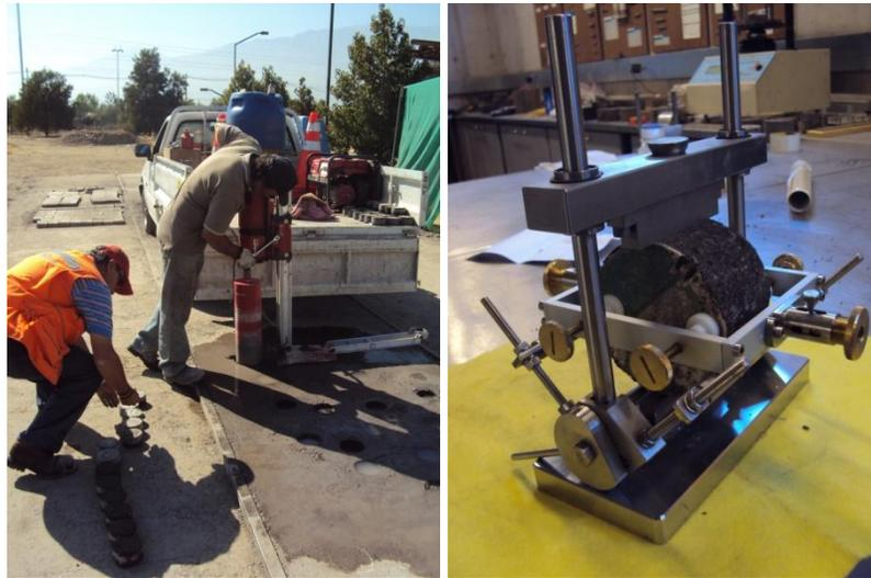
**Fotografía 20.-** Extracción de Testigos Asfálticos sobre Tramo de Prueba, para diámetros de 4 y 6 pulgadas. Ensayo de Módulo en equipo NAT para testigos asfálticos.
