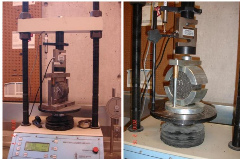
**Fotografía 14.-** Ensayo de Resistencia a la Tracción Indirecta ( ITS) sobre probetas Marshall con diámetro de 4 pulg. Ensayo Marshall para determinación de la Fluencia y Estabilidad de la mezcla asfáltica en frío (emulsión asfáltica).
