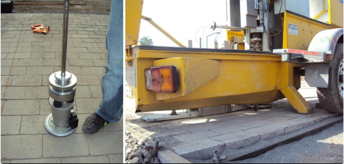
**Fotografía 17.-** Ensayo de Deflectometría de Impacto Liviano LFWD con Equipo Prima 100 sobre carpeta de Bloques de Asfalto. Ensayo de Deflectometría de Impacto FWD sobre carpeta de Bloques de Asfalto.
