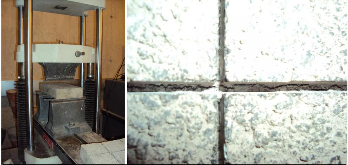
**Fotografía 19.-** Ensayo a la Flexión de Bloques de Asfalto. Inducción de Plano de Falla en ensayo de resistencia a la flexión de Bloques de Asfalto, bajo la ubicación de la ranura, con una profundidad entre 5 y 10 mm.
