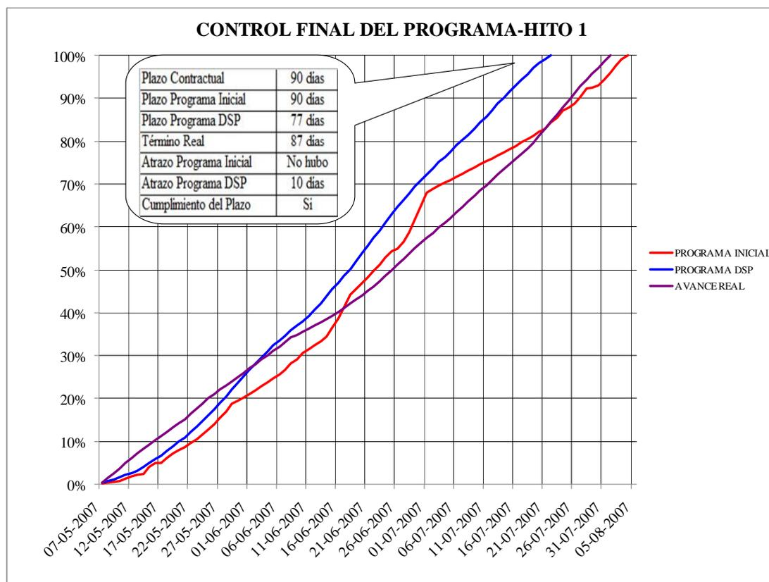
Figura 6-20: Control final del programa de producción
