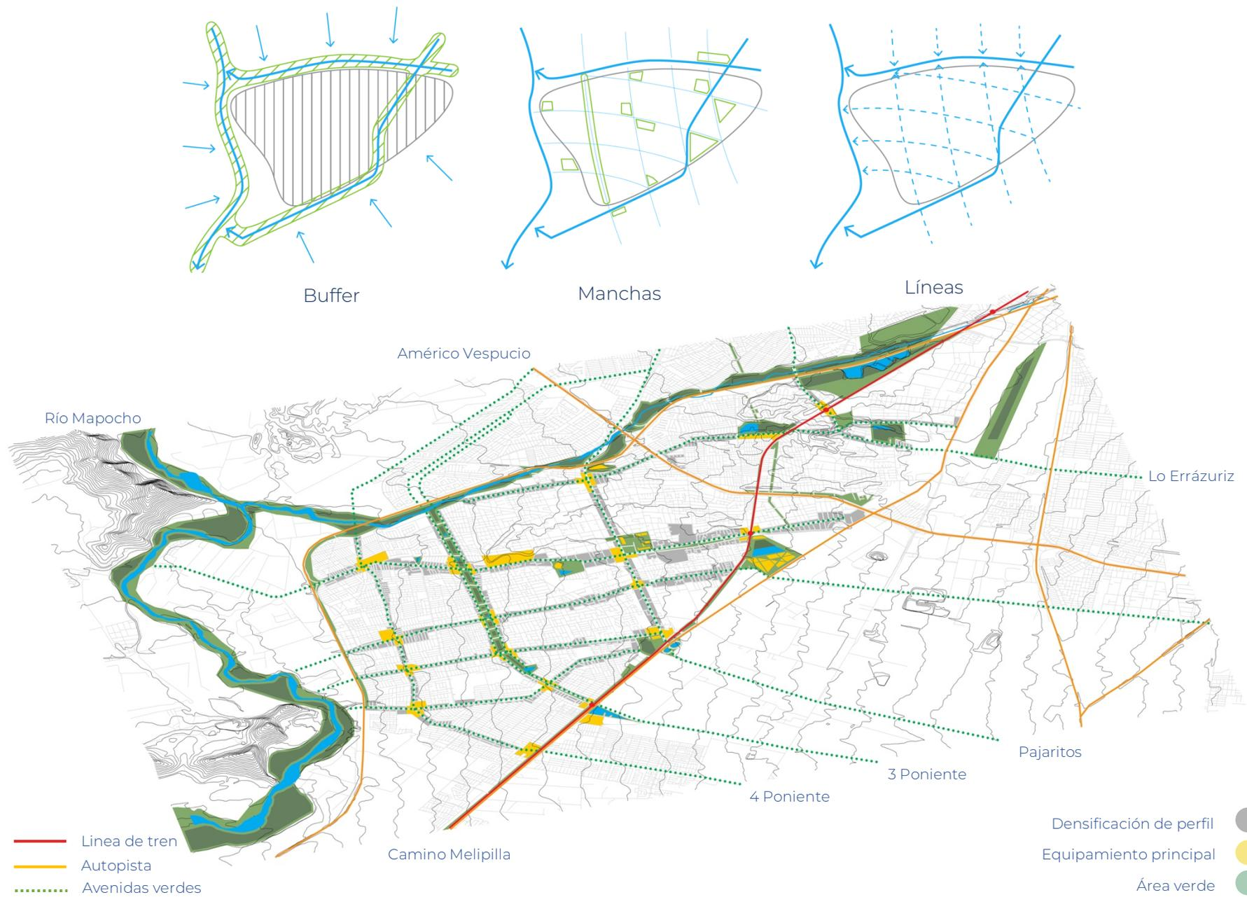
Figura 63: Macro escala: el Plan Maestro. Arriba: esquemas proyectuales, respectivamente: el buffer, las manchas y las líneas.
