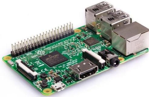
**Figura 8-3 Imagen de un Raspberry Pi 3 Modelo B.** Nos presenta la tarjeta utilizada por el autor para el procesamiento de imágenes Copyright 2020 Raspberry pi Foundation.
