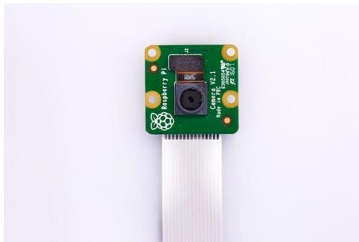
**Figura 8-4 Imagen de una cámara modulo V2.** Presenta la forma de la cámara encargada de la captura de imágenes en el accesorio Copyright 2017 Raspberry pi Foundation.
