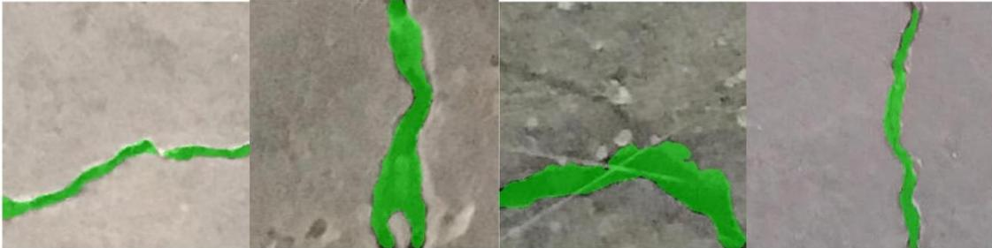
**Figura 9-7 Precisión de la segmentación por Dung y Anh 2019.** Muestra como la segmentación logra cubrir el ancho de la fisura en su totalidad con gran precisión Copyright 2019 Dung y Anh.
