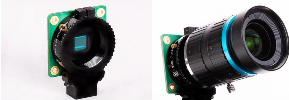
**Figura 11-2 Imagen de una cámara Raspberry Pi.** Muestra la última cámara en el mercado de Raspberry Pi Copyright 2020b Raspberry pi Foundation
