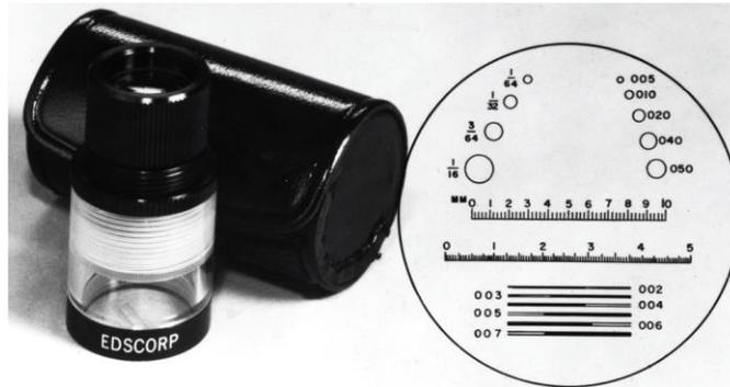
**Figura 9-1 Comparador de fisuras.** Comparador de fisuras para medir anchos de fisura en sitio Copyright 2007 ACI Committee 224.
