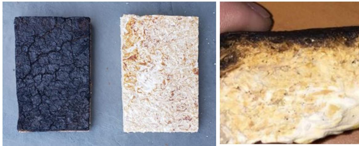
Fig 8-12: 1.- Comparación de biomaterial carbonizado y sin carbonizar. 2.- Acercamiento de sección de pieza carbonizada de biomaterial. Elaboración propia.
