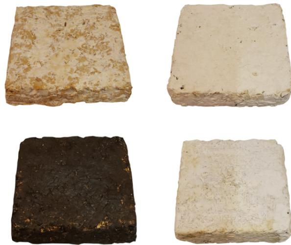
Fig 6-1: Probetas para testeo de absorción de agua y propiedades aislantes. a) Sin tratamiento. b) Recubrimiento de cal. c) Carbonizado exterior. d) Carbonizado exterior y recubrimiento de cal. Elaboración propia.
