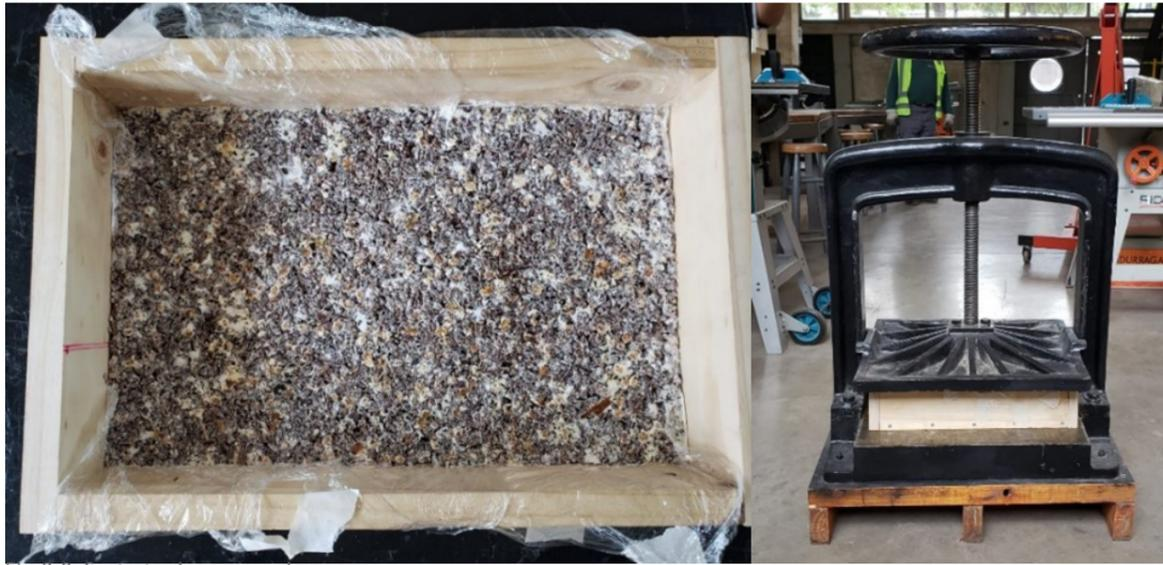
Fig 8-9: Sustrato de cascara de nuez molida inoculada en el molde y proceso de prensado. Elaboración propia.
