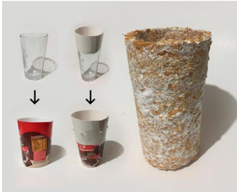
Fig 8-5: Construcción de molde y prototipo de lampara terminado. Elaboración propia.
