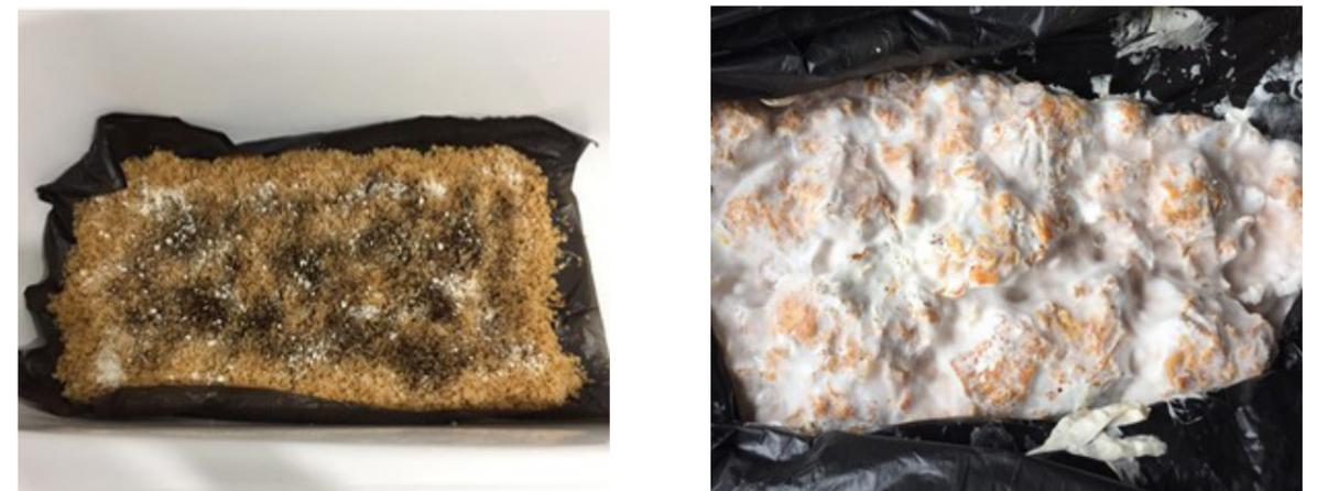
Fig 8-4: Primer y último día de crecimiento del micelio en sustrato de viruta de pino. Elaboración propia.
