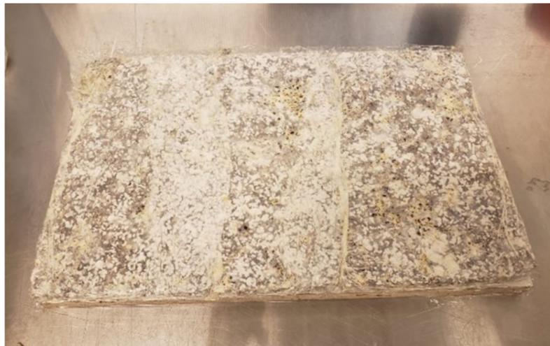
Fig 8-10: Crecimiento del micelio fuera del molde para lograr terminación. Elaboración propia.
