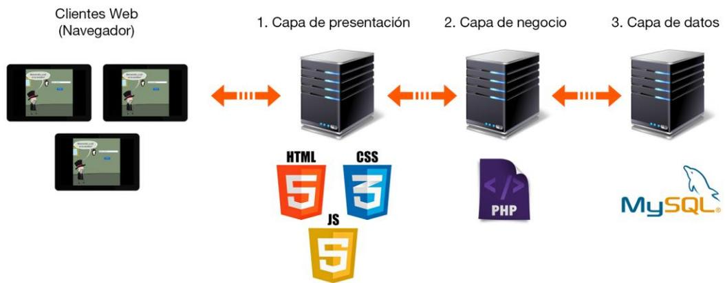
Figura 4-1: Arquitectura de software del instrumento
