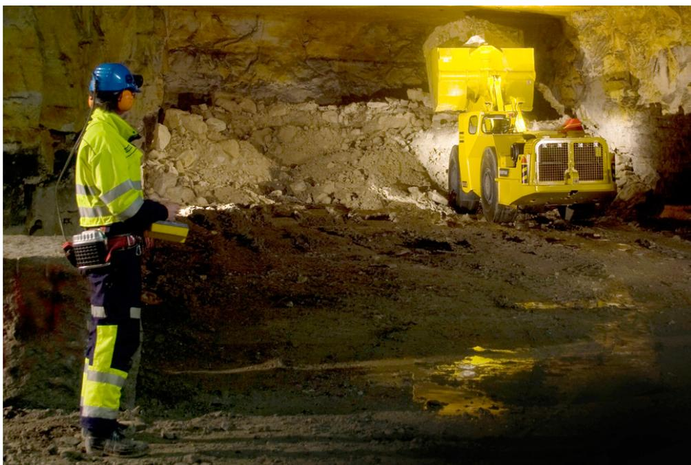
FIGURA 1.4. LHD (Load Haul Dump) manejado mediante control remoto por operario de Atlas Copco.
