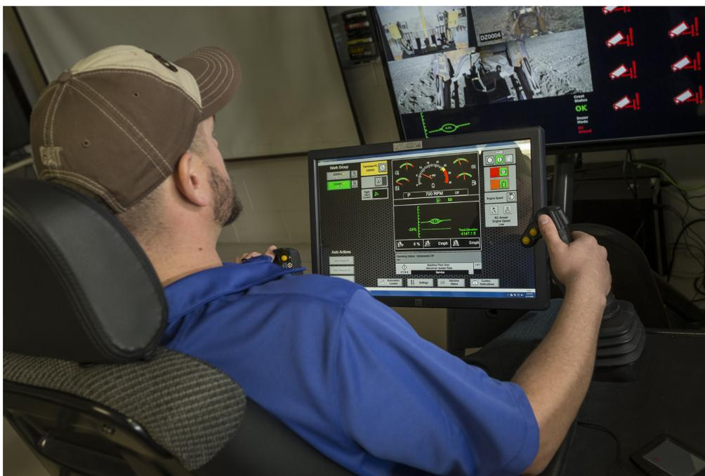
FIGURA 1.5. Operación remota de bulldozers Caterpillar en minas de carbón.
