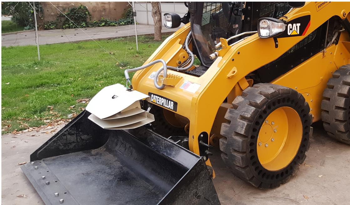
FIGURA 7.5. Plataforma de prueba CAT262C con el sensor SICK LMS511 instalado.
