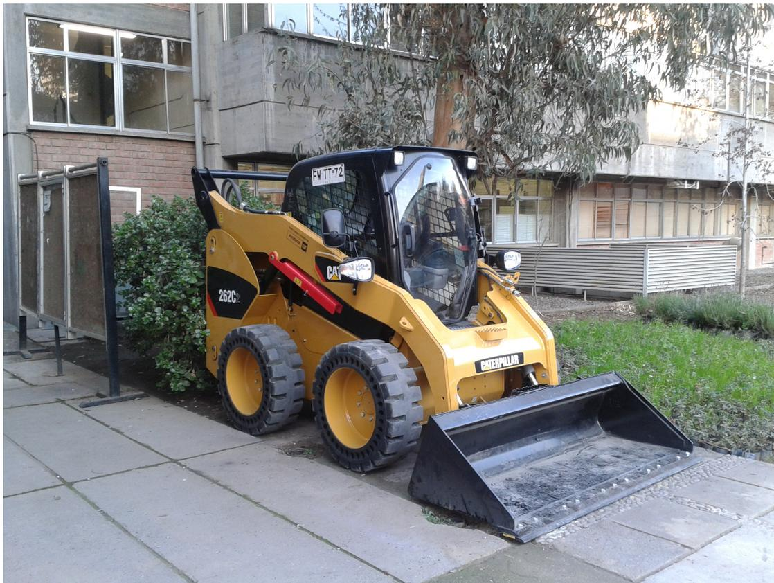
FIGURA 7.4. Plataforma de prueba CAT262C sin modificaciones.
