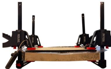
**Figura 42.** Prensado en frío del tablero.
