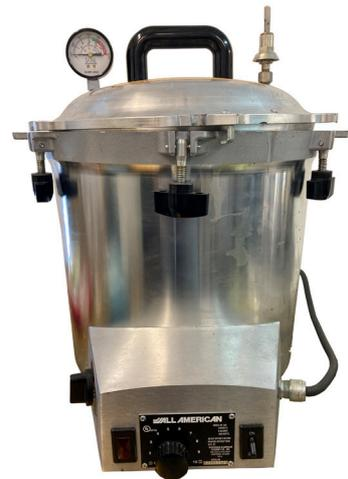
**Figura 37.** Olla autoclave.
