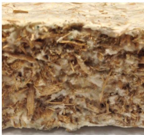
**Figura 10.** Vista ampliada de un tablero de micelio que muestra la distribución de partículas (rastrojo de maíz) dentro de la matriz de micelio (blanco) \*
