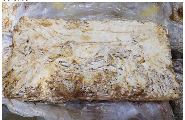
Fotografía de un bloque de micelio recién sacado del molde
