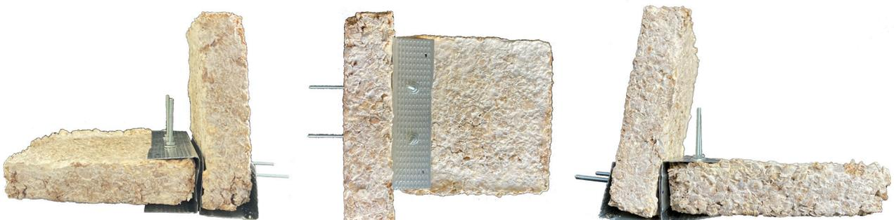
**Figura 44.** Detalle unión entre tableros.
