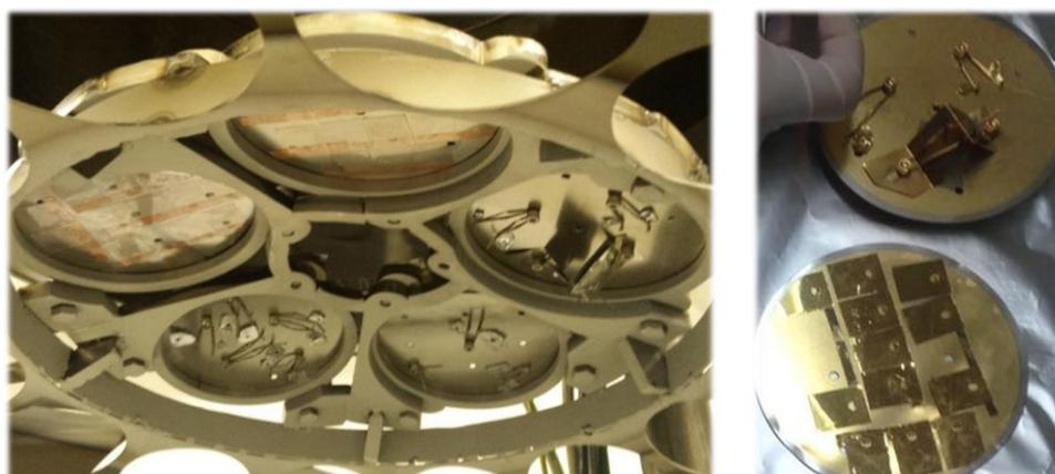
*Figura 56: se pueden apreciar los porta muestras circulares conteniendo varias muestras y además montados en el soporte principal.*
