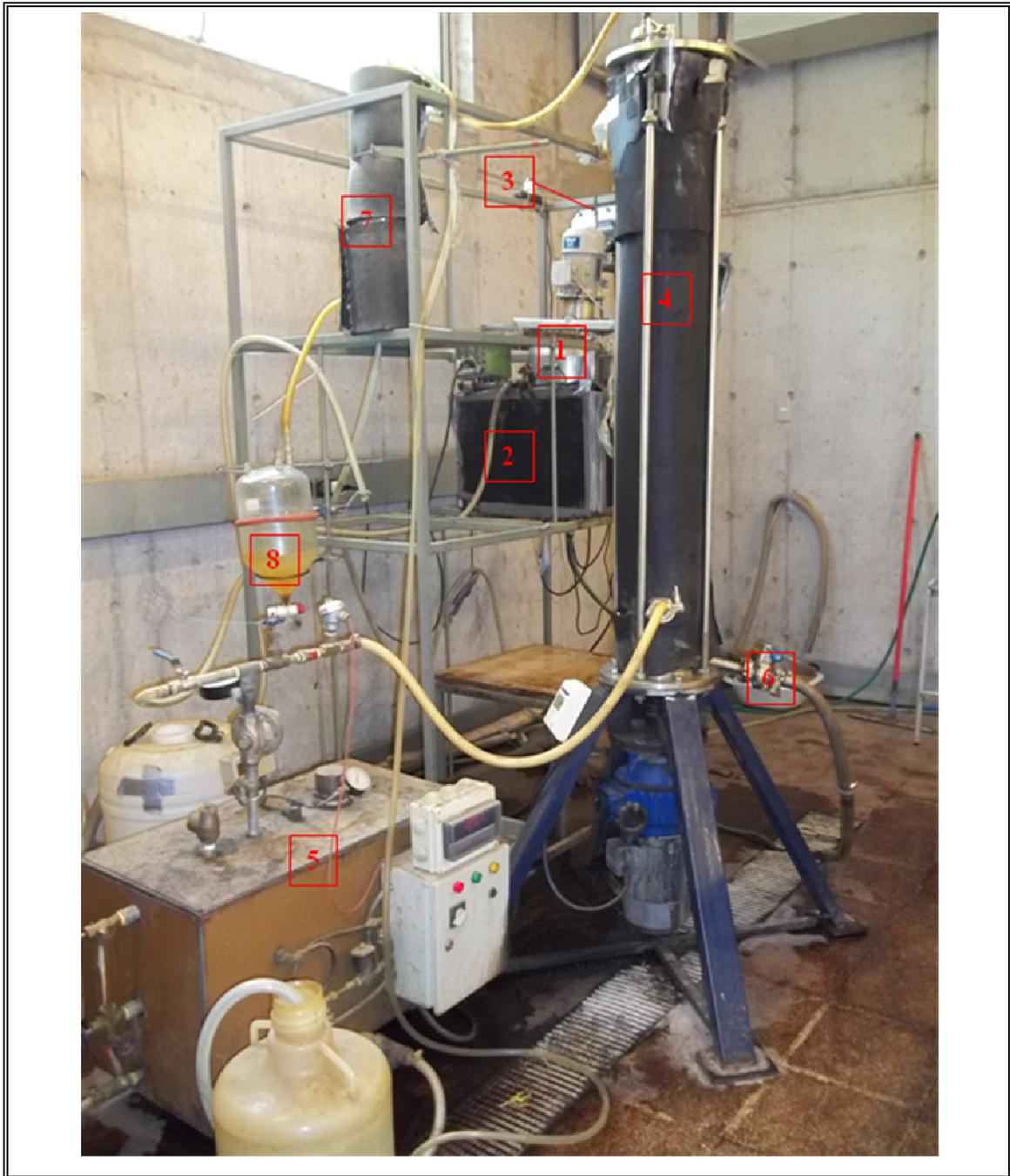
Figura 2.6: Columna de Conos Rotatorios: 1) Estanque alimentación, 2) Baño termostatado, 3) Bomba peristáltica, 4) CCR, 5) Calderín, 6) Válvula de Purga, 7) Condensador y 8) Decantador.
