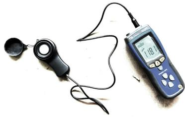
a) Luxómetro: PCE - 174 DATALOGGING LIGHT METER
