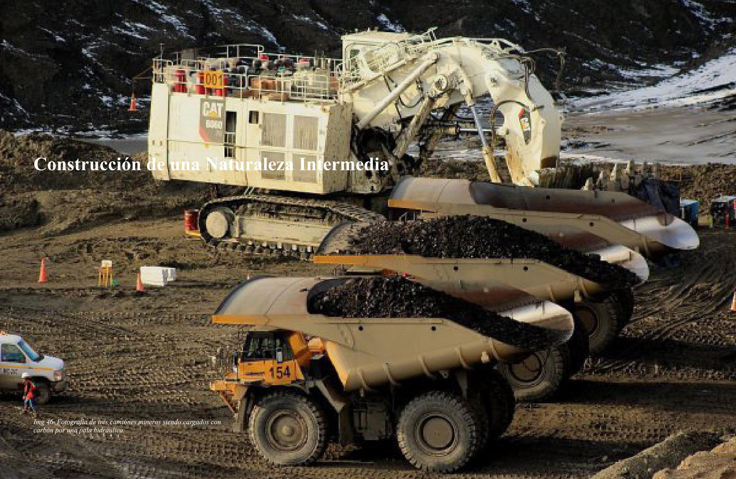
*Img 46. Fotografía de tres camiones mineros siendo cargados con carbón por una pala hidráulica.*
