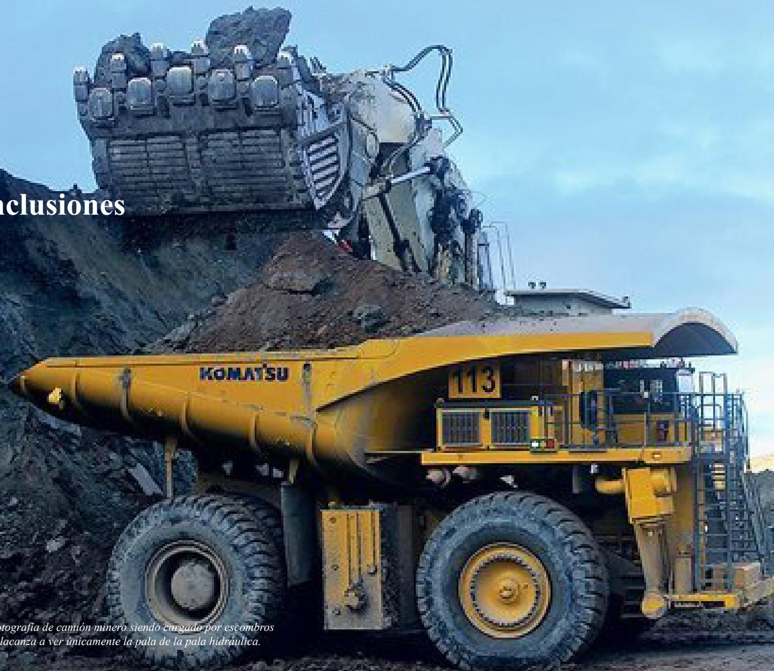
*Img 80. Fotografía de camión minero siendo cargado por escombros donde se alcanza a ver únicamente la pala de la pala hidráulica.*
