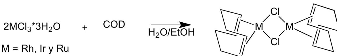
**Figura 31** Esquemas de síntesis para el complejo  $[\text{Ru}(\text{COD})\text{Cl}_2]$ ,  $[\text{RhCl}(\text{COD})]_2$  y  $[\text{Ir}(\text{COD})\text{Cl}]_2$ .
