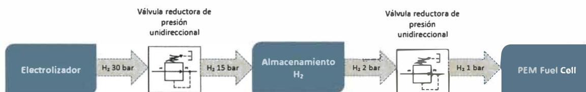
Fig. 5-5 Esquema línea de presión.
