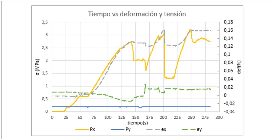
Figura 6.22. Ensayo 3. Gráfico Tensión-deformación-tiempo.  $\sigma_2=0.2$  MPa
