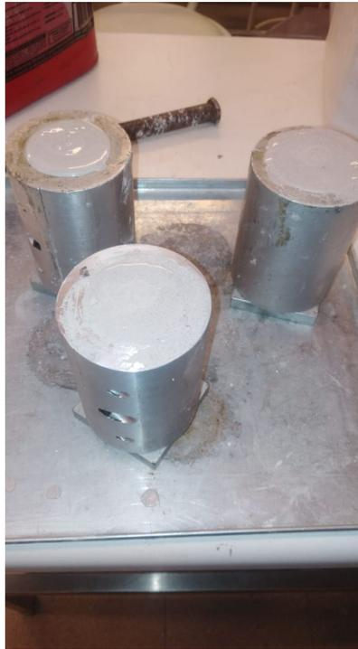
(a) Probetas en proceso de fraguado
