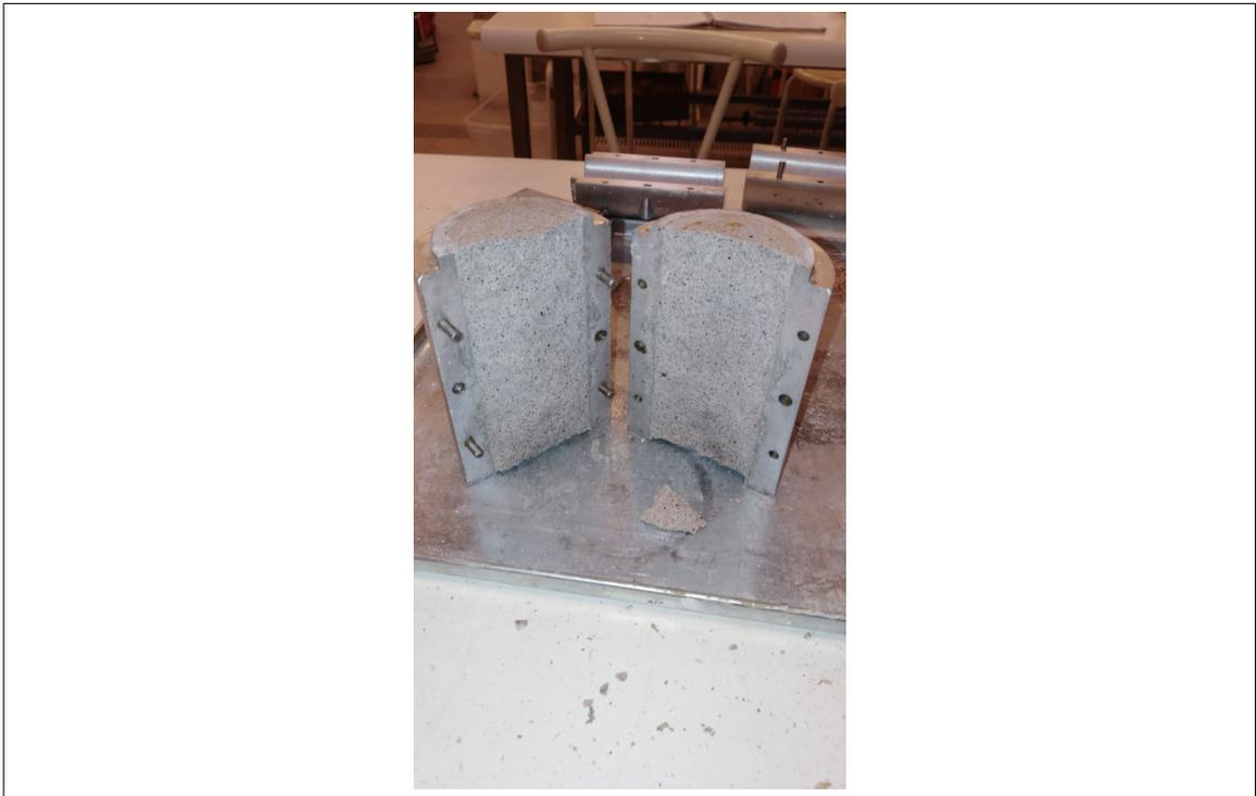
Figura 4.2. Probetas rotas al desmoldarse
