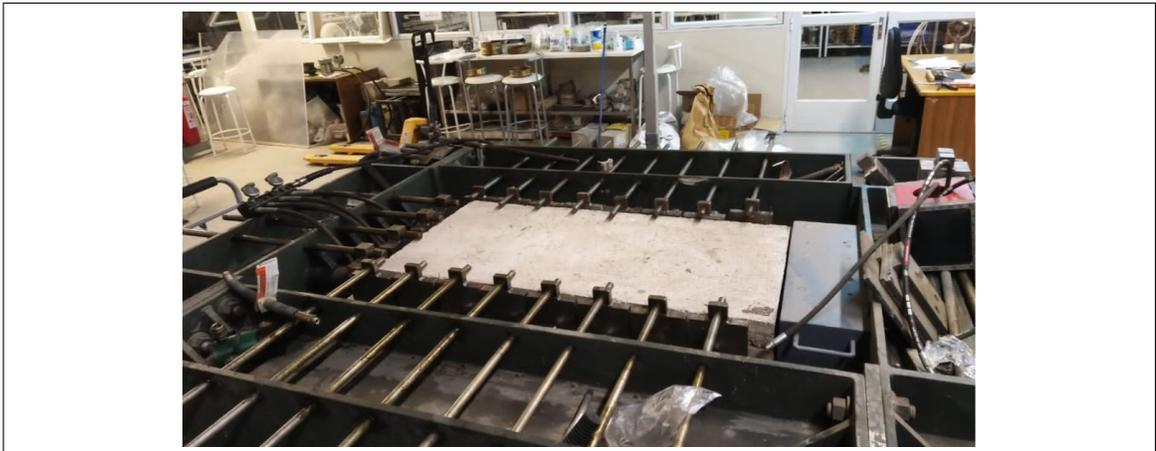
Figura 5.1. Vista general marco biaxial con probeta en él
