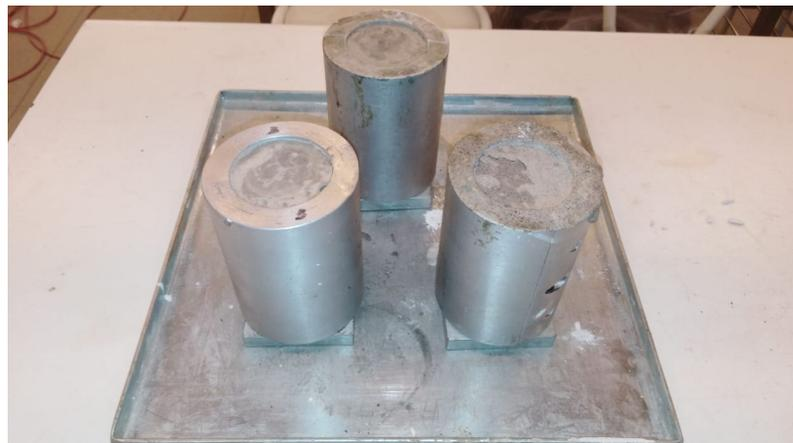
(b) Probetas con 30 minutos de fraguado
