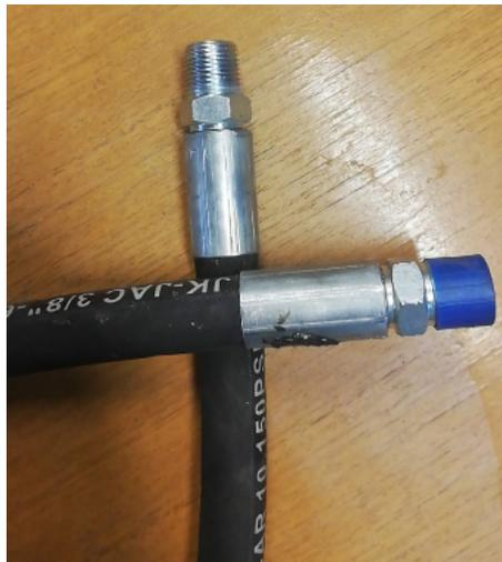
(c) Manguera manifold-gato hidráulico
