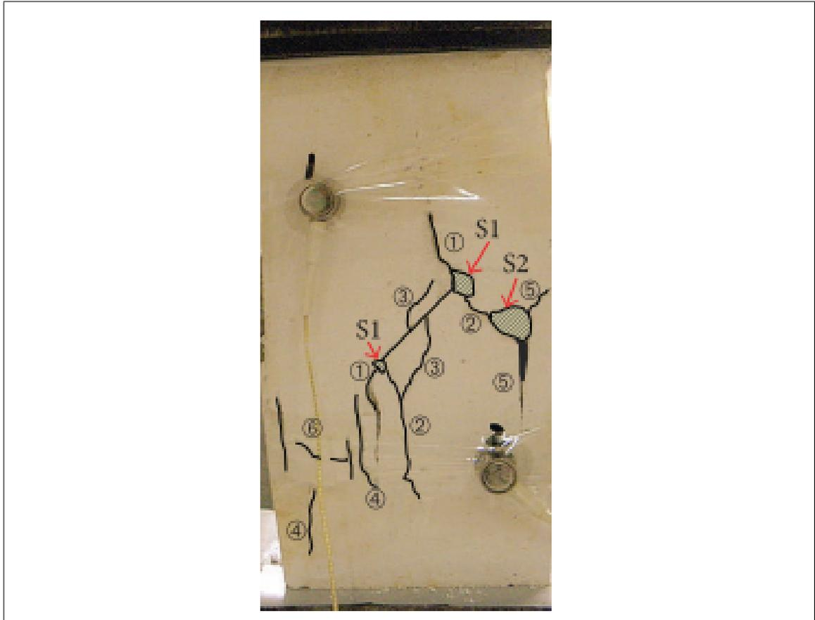
Figura 3.9. Propagación de fractura simple para caso biaxial. (a)  $\sigma_1=2.45$  MPa. (b)  $\sigma_1=2.87$  MPa. (c)  $\sigma_1=3.33$  MPa. (d) Falla. (Liu, 2016)
