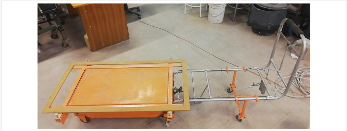
Figura 5.5. Carro habilitado para elevar probeta dentro del marco biaxial
