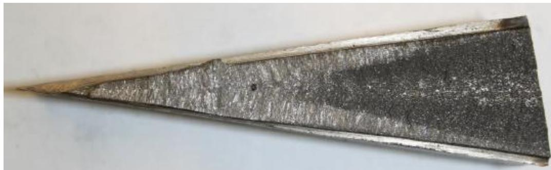
Figura 2-2: Fotografía de una fundición coquillada (König, 2011).
