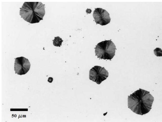
Figura 2-3: Micrografía de una fundición dúctil (Radzikowska, 2005).
