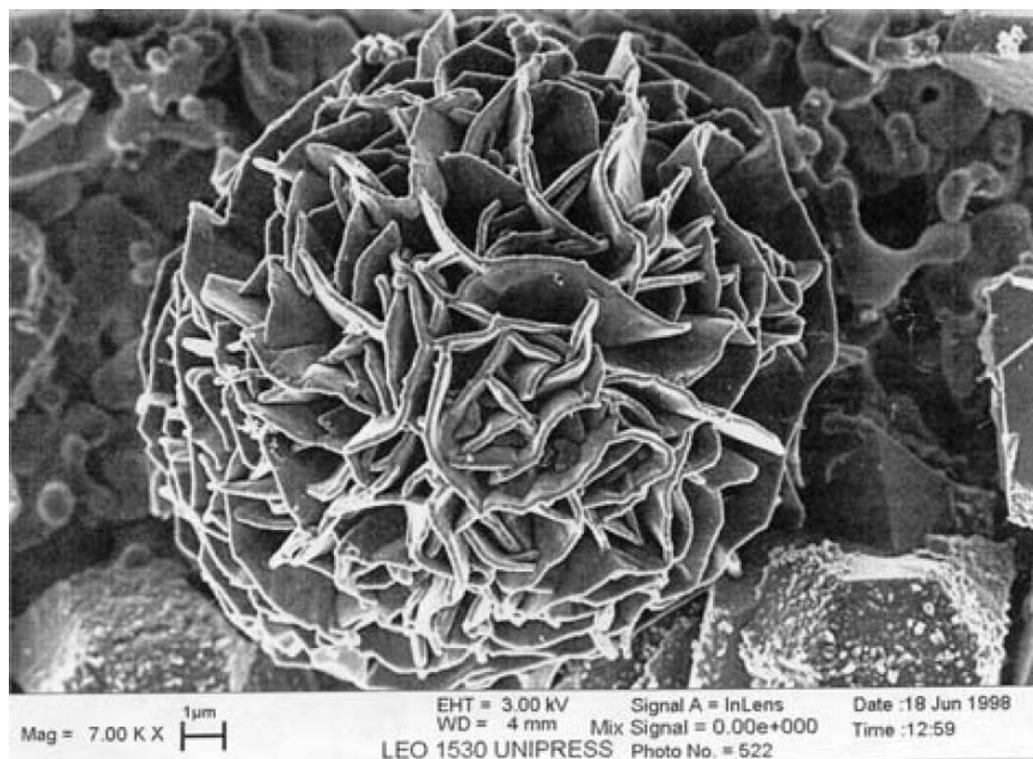
Figura 2-13: SEM de un grano eutéctico gris (Fraś *et al.*, 2007).
