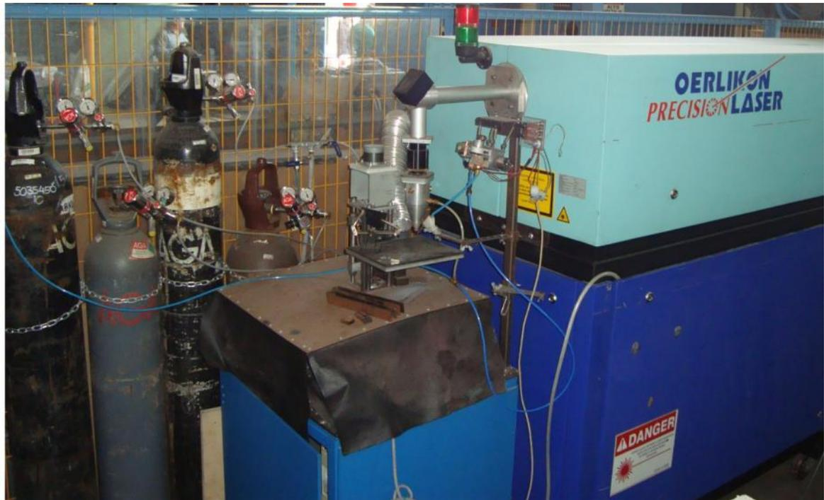
Figura 3.1: Vista del laboratorio, a la izquierda gases para el láser, al centro el posicionador cartesiano, extractor, atril, dispensador de polvos y cabezal láser, a la derecha el resonador láser.
