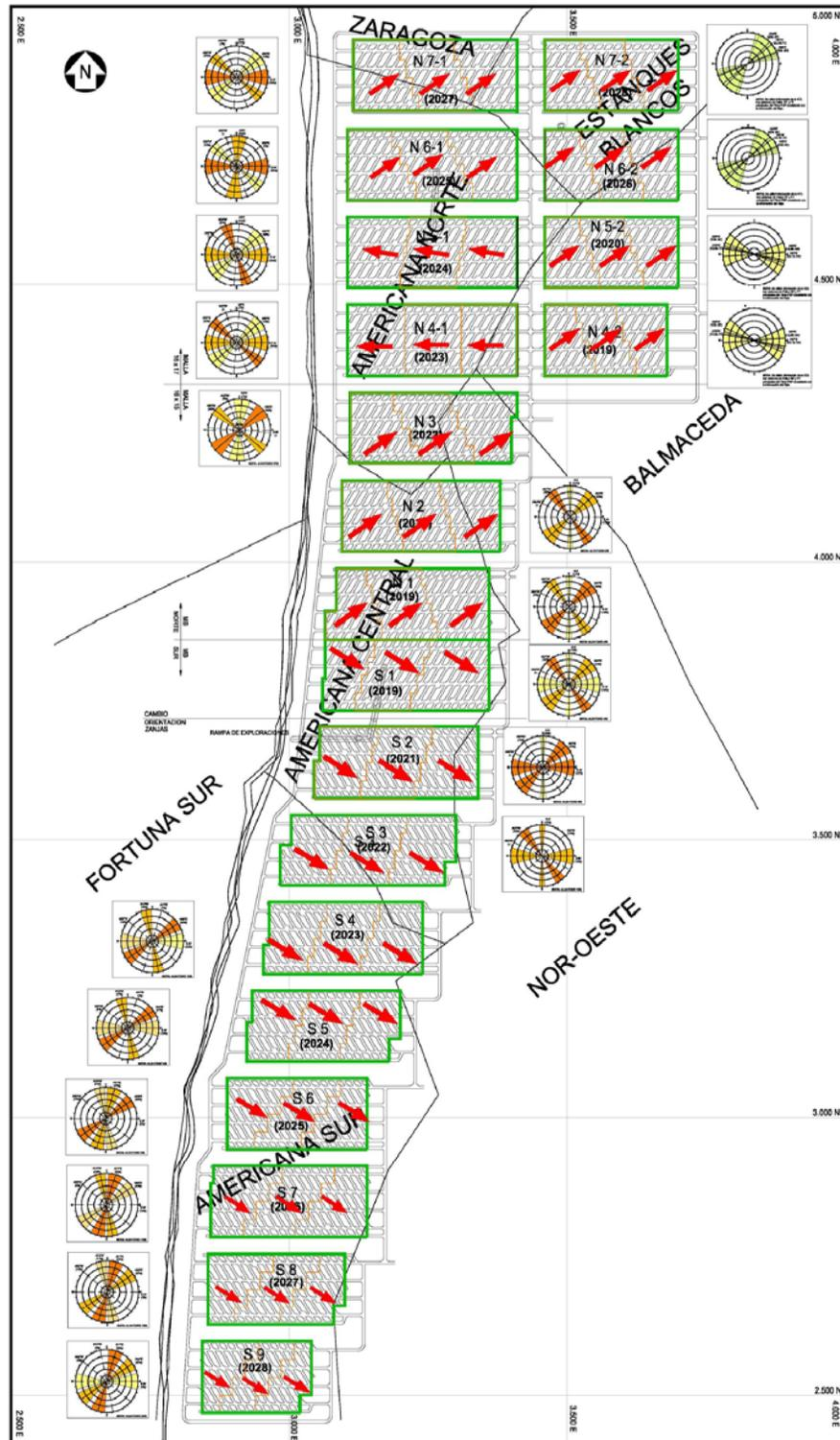
Figura 19: Orientación y sentido de avance de hundimiento por macro bloque (Fuente: Codelco)
