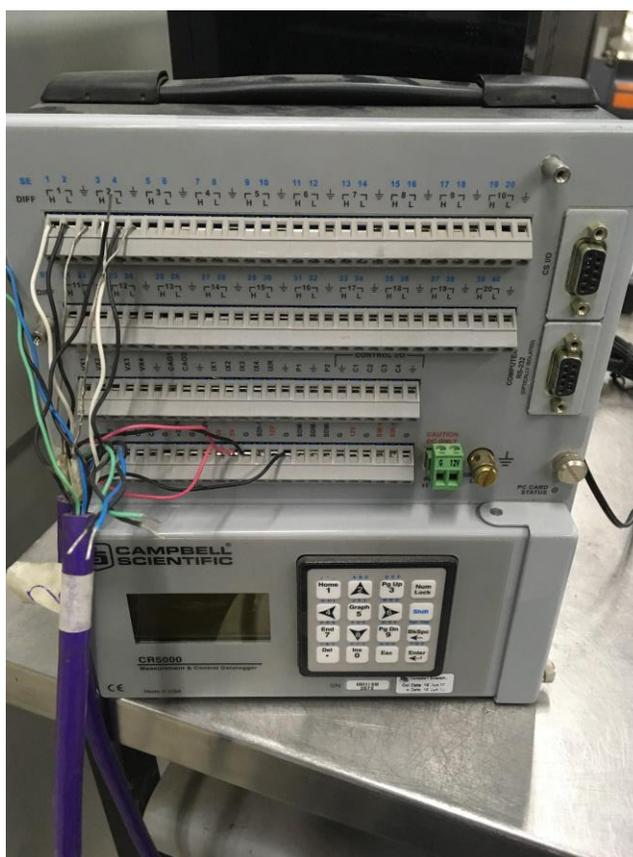
Figura 5-5: Celda de Presión conectado a Datalogger
