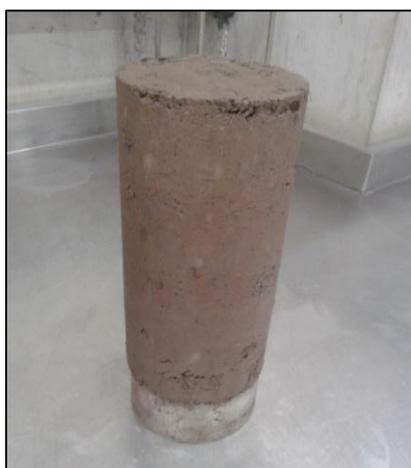
Figura B-4: Probeta ensayo Módulo Resiliente
