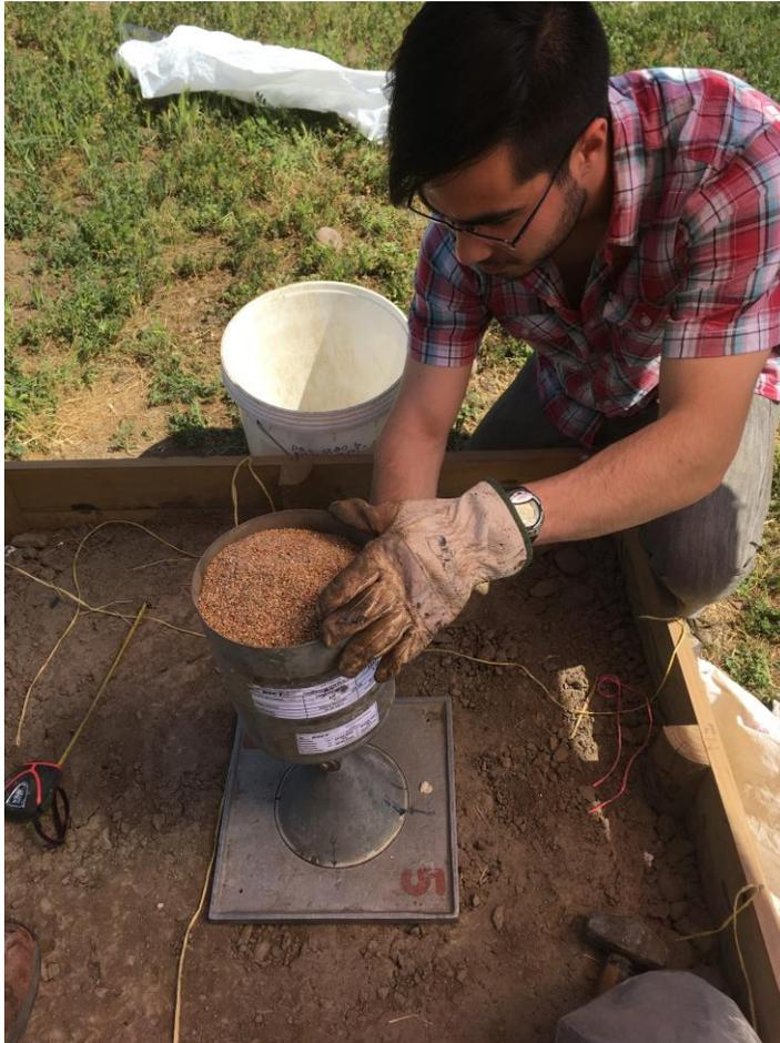
Figura B-7: Verificación de Densidad: Cono de Arena
