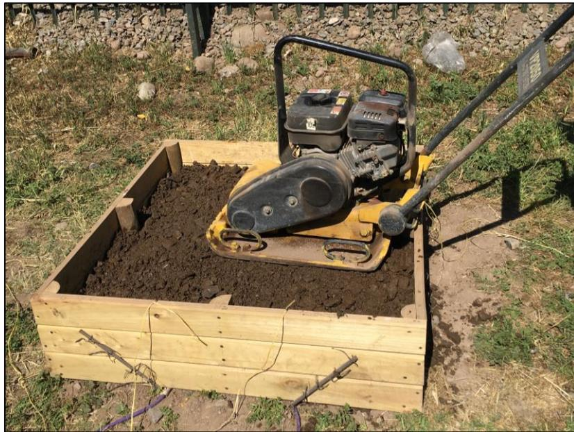
Figura 5-14: Compactación de la estructura de prueba
