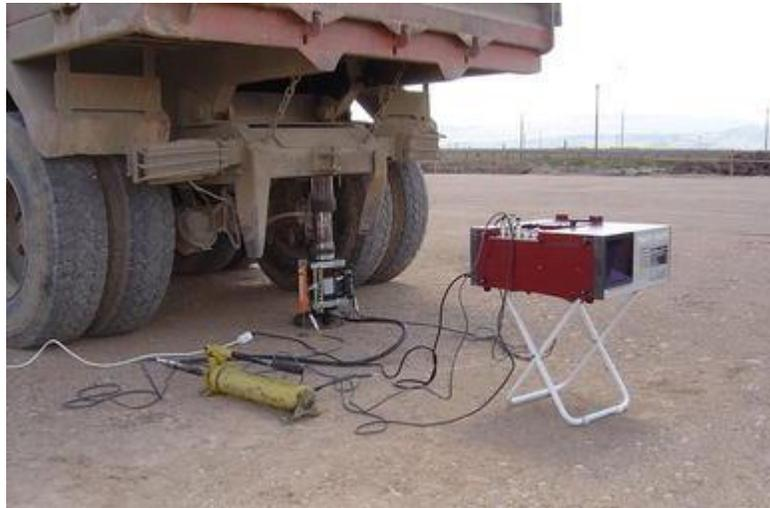
Figura 3-4: Ensayo de plato de carga in situ (Gul y Ceylanoglu, 2013)
