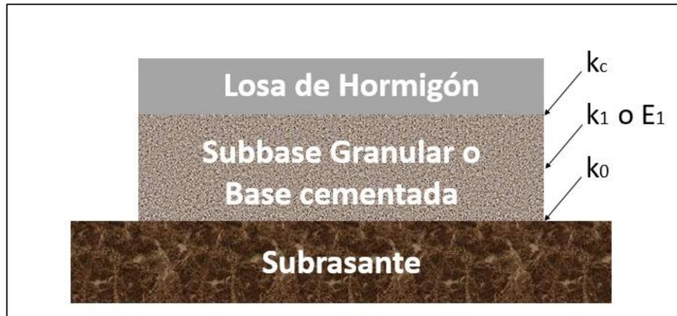
Figura 3-5: Pavimento Rígido y Módulo de Reacción combinado  $k_c$
