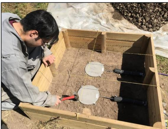
Figura 5-13: Colocación de Celdas en estructura de prueba
