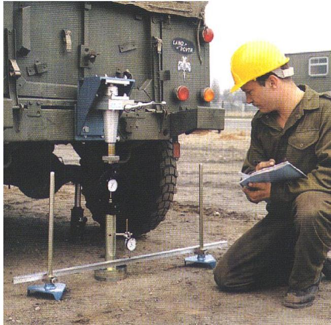
Figura 4-3: Ensayo de CBR in situ
