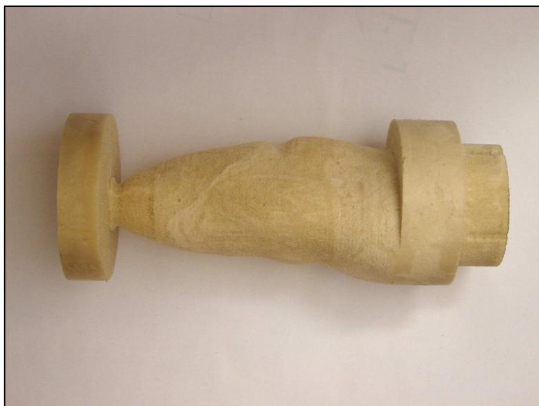
Figura 6.8: Molde de pedilén recién mecanizado
