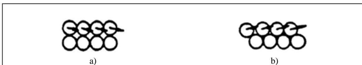
Figura 4.1: Movimiento de las partículas debido a corte. a) estado más suelto, b) estado más denso
