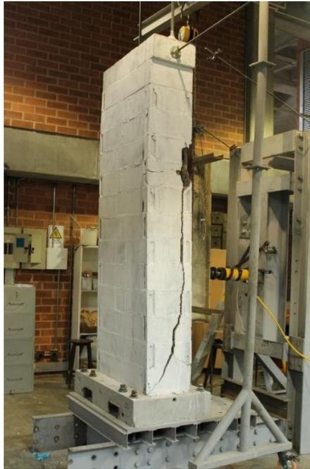
**Figura 7. 17. Tipología de falla por corte presentada en los muros diafragma ensayados.**
