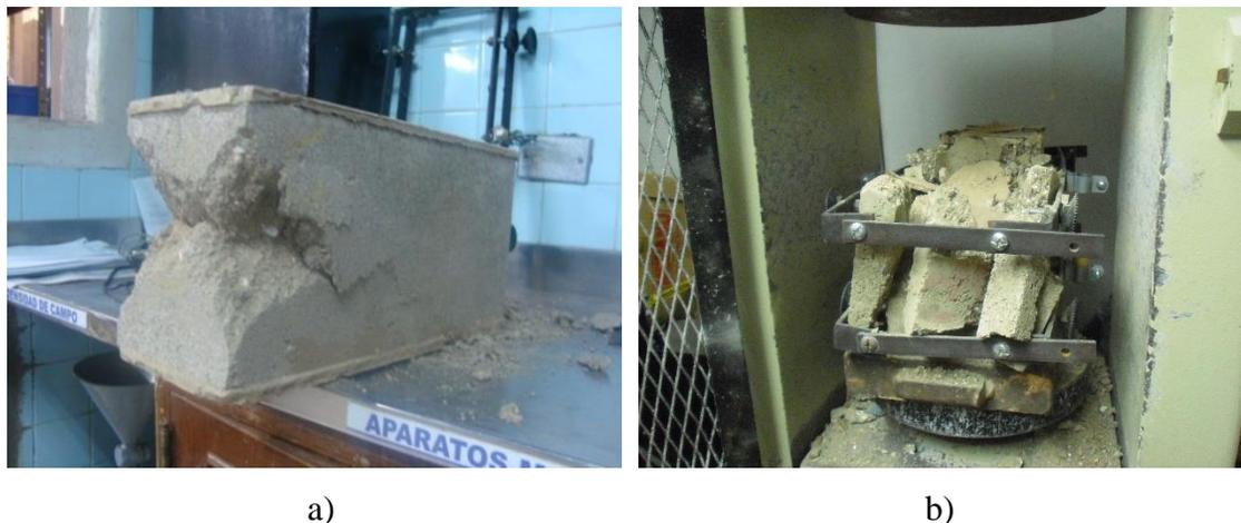
**Figura 3. 7 Tipos de Falla, a) Falla diagonal de corte, típica en bloques de baja y media resistencia, b) Falla explosiva, típica en bloques de alta resistencia.**
