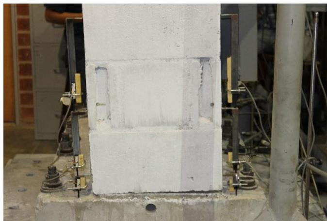
Figura 7. 21. Tipología de comportamiento “rocking” generada en el ensayo (Wall 9).
