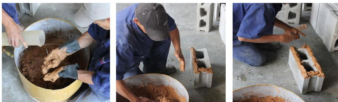
**Figura 4. 11 Elemento de contacto en arcilla.**
