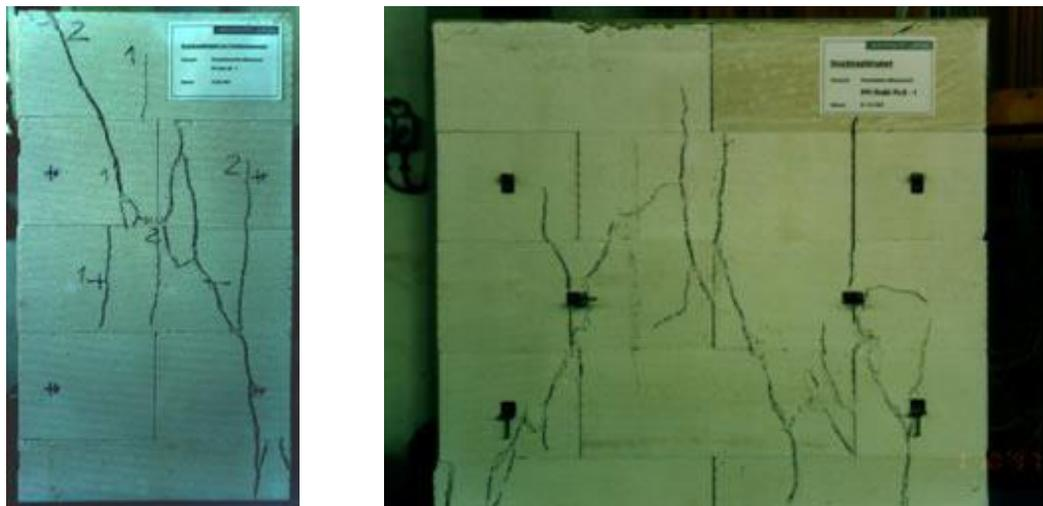
**Figura 4. 3 Tipología de falla para albañilería sin elemento de contacto (en seco) (Marzahn, 1997).**
