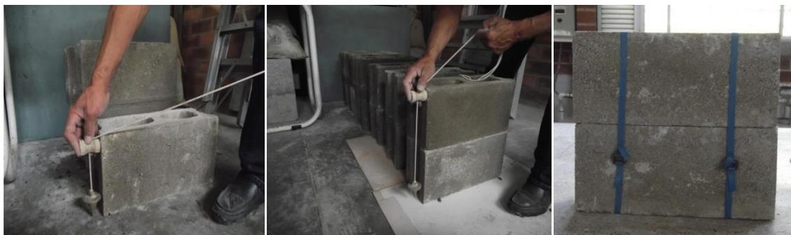
Figura 4. 10 Elemento de contacto en seco.
