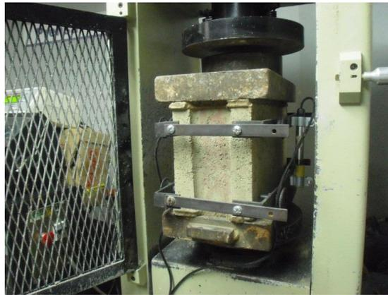
**Figura 3. 2 Montaje experimental de las probetas ensayadas.**
