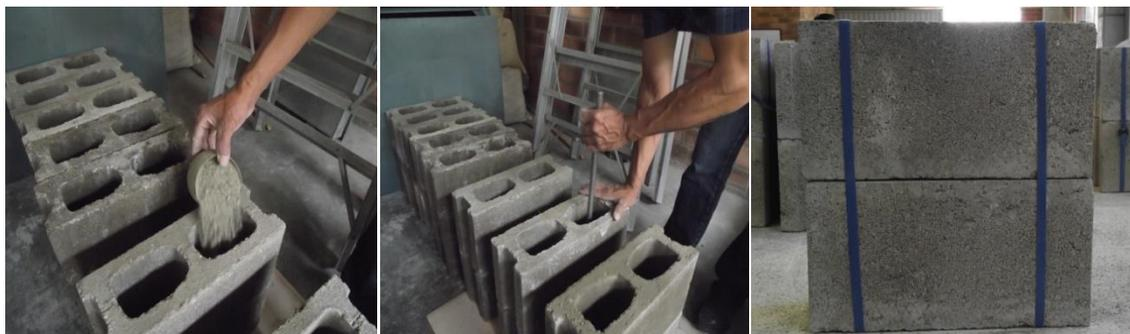
**Figura 4. 8 Elemento de contacto relleno de arena.**
