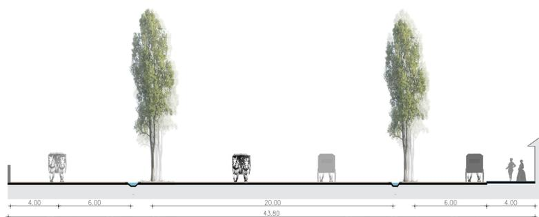
**Figura 22b:** Sección Transversal Camino de Cintura según propuesta de 1873.
