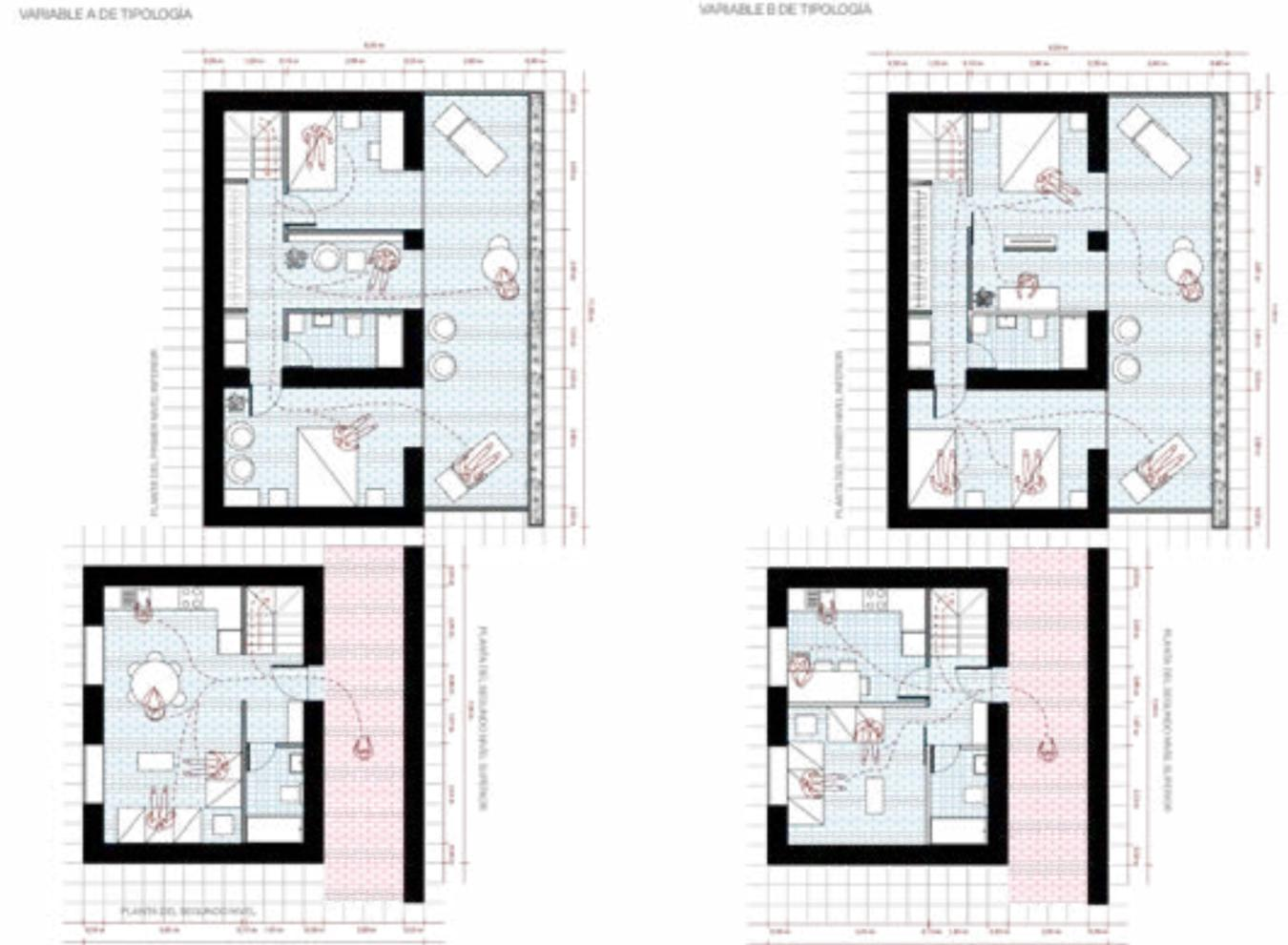
Fig. 324 Esquemas y plantas de tipología III departamento dúplex doble fachada. Fuente: Elaboración propia.
