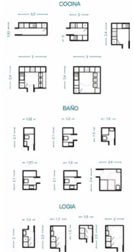
Fig. 190 Distintas disposiciones del mobiliario básico, las cuales conforman distintos espacios que dan dimensiones a los recintos. Fuente: Elaboración propia
