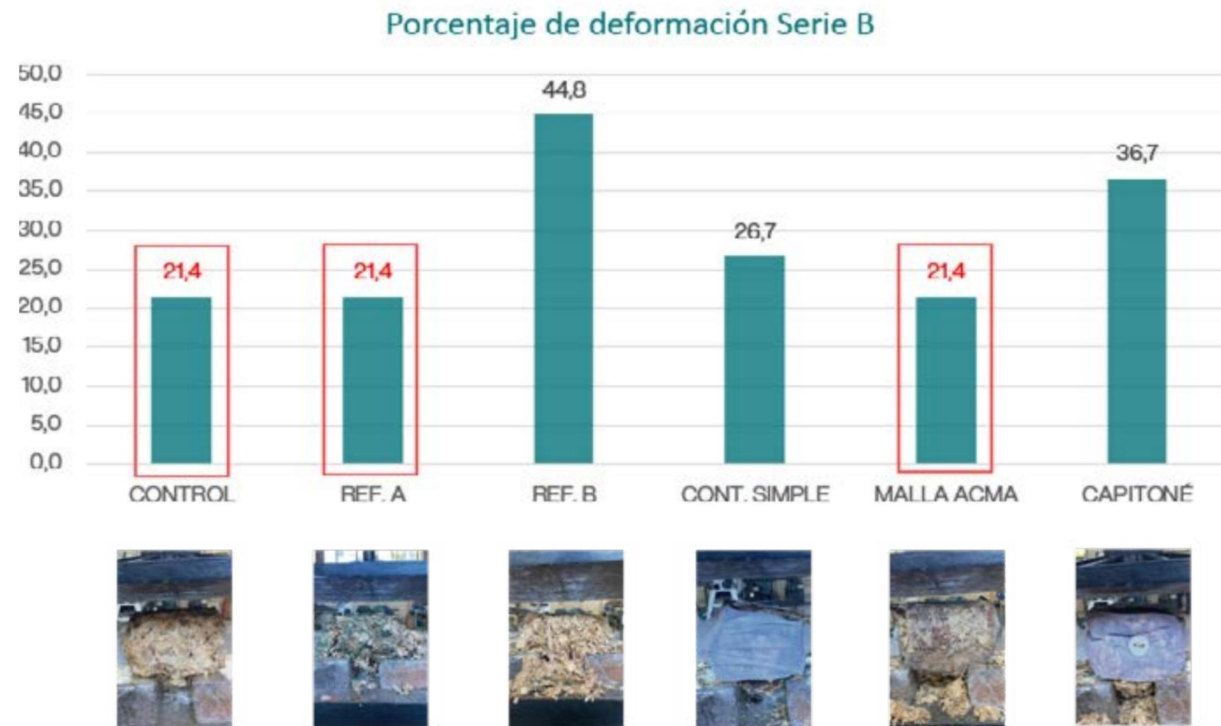
Fig. 166 Gráfico comparativo según porcentajes de deformación obtenidos. Fuente: Elaboración propia.
