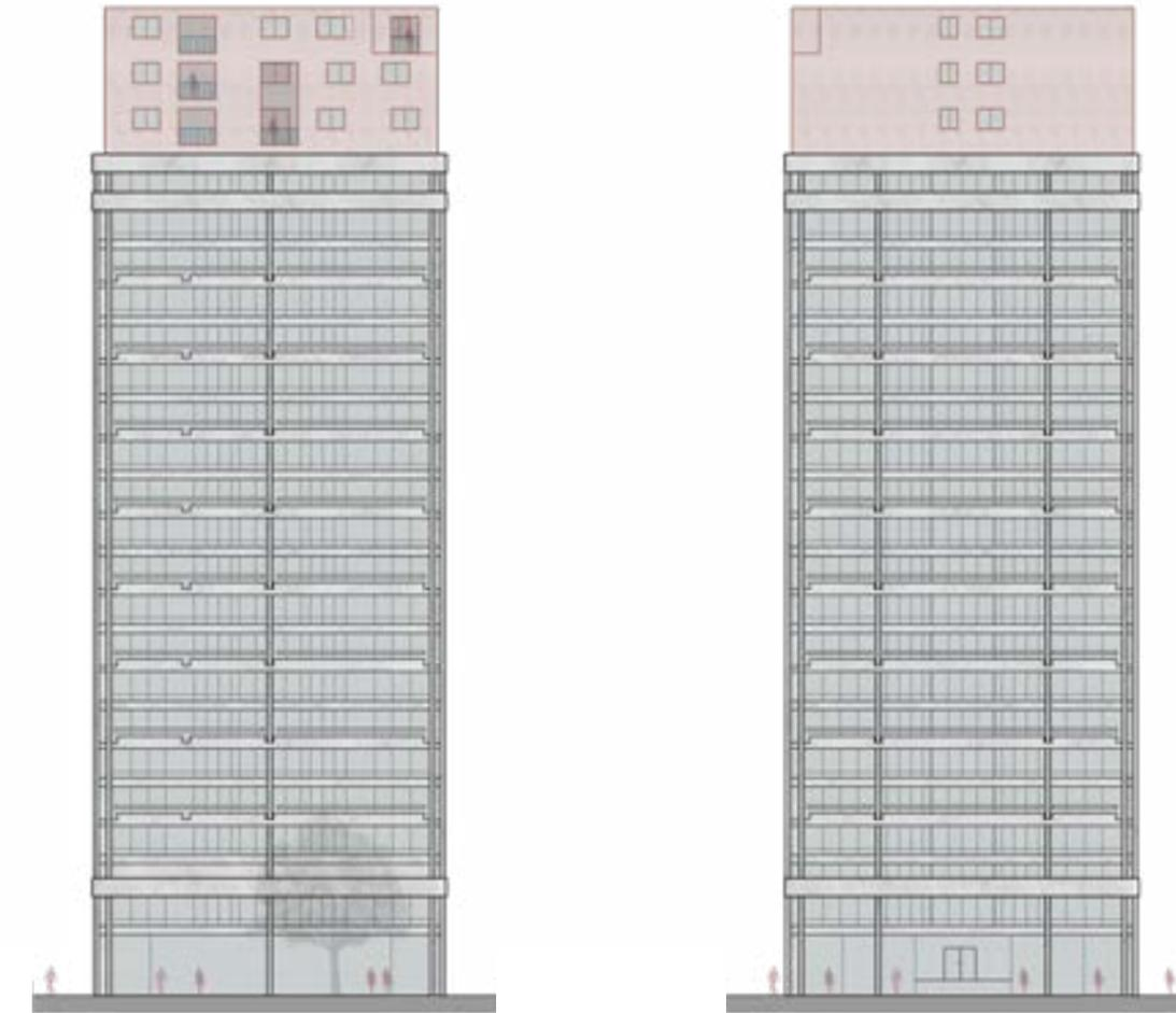
Fig. 309 Elevaciones de una de las torres de planta cuadrada que enfrenta la calle Carabineros de Chile. En rojo se presenta el proyecto diseñado con el sistema constructivo propuesto. Ambas elevaciones dan cuenta de una continuidad volumétrica de la torre. En la elevación ubicada a la izquierda se observa que el proyecto (en rojo) cuenta con una mayor cantidad de vanos en comparación a la parte del proyecto que se presenta en la elevación ubicada a la derecha.
