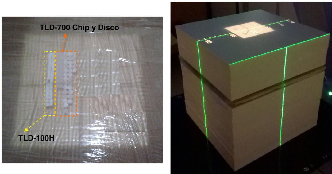
**Figura 2-3.** Irradiación de los TLDs. **Imagen izquierda:** Muestra los diferentes tipos de TLDs posicionados dentro del tamaño de campo luminoso de 15x15 cm<sup>2</sup>. **Imagen derecha:** Muestra como finalmente quedaron los TLDs dentro de los bloques de agua sólida.
