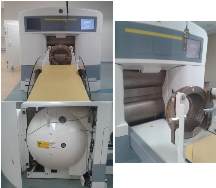
**Figura 1-7. Imagen arriba a la izquierda:** Unidad GKL4C del Hospital Militar de Santiago de Chile. **Imagen inferior izquierda:** Blindaje que recubre el cuerpo central de la máquina. **Imagen derecha:** Casco colimador de 4mm adosado a la camilla, además de las puertas de blindaje que se mantienen cerradas mientras la máquina no esté en modo tratamiento.
