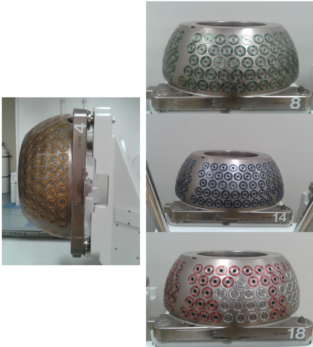
**Figura 1-11.** Cascos colimadores con sus distintos diámetros de 4, 8, 14 y 18 milímetros. **Imagen izquierda:** Muestra el casco colimador de 4mm unido a la camilla deslizante. **Imagen inferior derecha:** Muestra el casco de 18mm con varios de los colimadores que lo conforman, bloqueados con tapones de hierro.
