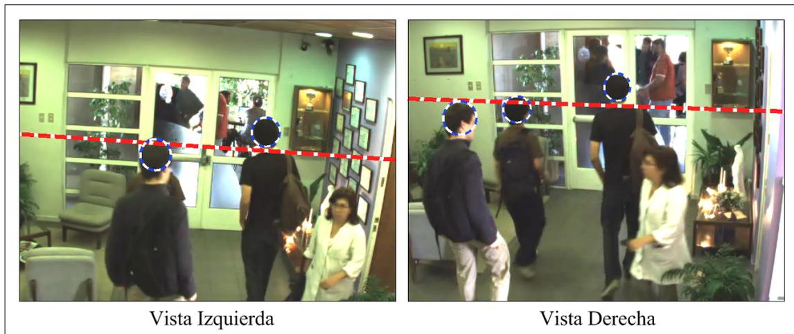
FIGURA 6.12. La gran longitud de la línea base (1.7 m.) permite una muy buena discriminación en caso de de oclusiones, aunque con un mayor tiempo de cómputo para estimar la geometría epipolar que un caso más simple (línea base menor).
