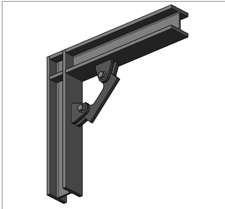
Figura 2.20. DENITC, sus componentes de anclaje y su ubicación en la zona de unión viga-columna.
