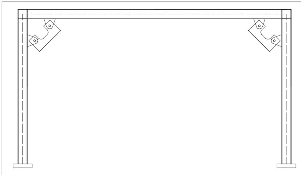
Figura 2.10. DENITC incorporado a un marco de acero resistente a momento
