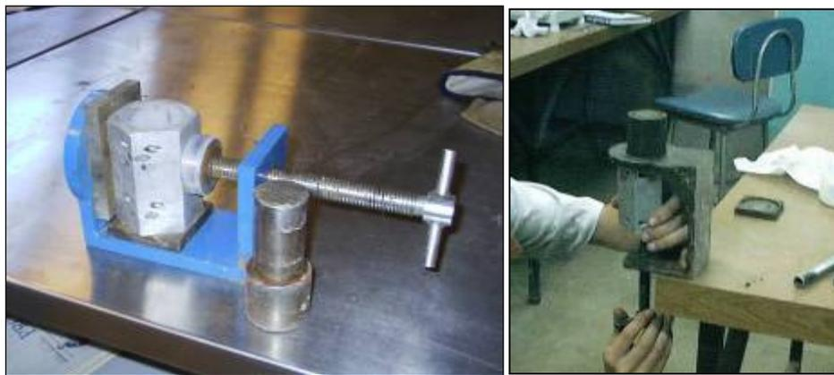
**Figura 5 y 6.** Molde y extracción de la probeta.
