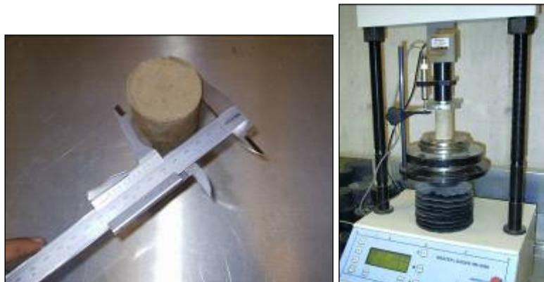
**Figura 3.** Probeta de suelo estabilizado, montada en la prensa de carga.
