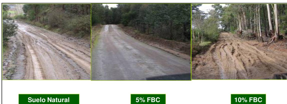
Figura VI-15: Tramos de Ecobel después de 8 meses de funcionamiento en temporada lluviosa.
