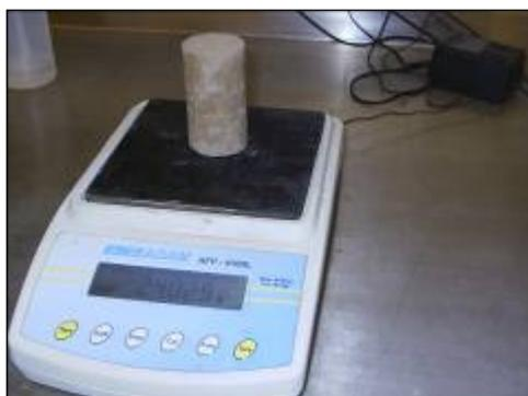
**Figura 1 y 2.** Medición de masa y dimensiones de la probeta.
