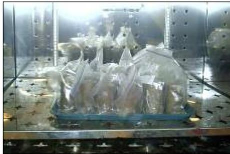
**Figuras 7.** Detalle de probetas en período de curado, en la cámara ambiental.
