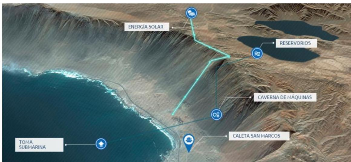
**Figura 3 Esquema central hidráulica de bombeo, proyecto Espejo de Tarapacá**
