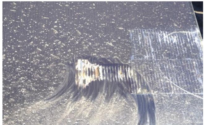
Imagen 06. Polvo y tierra en un modulo solar fotovoltaico en PV Diego de Almagro
