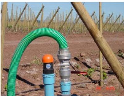
Válvula de aire y cargado de pulverizadora
