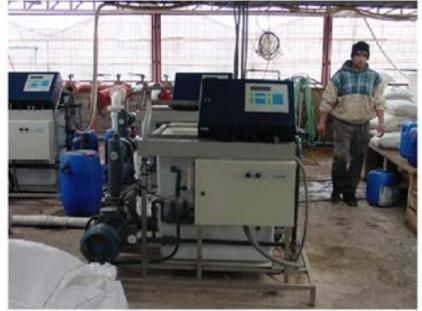
inyector de fertilizante con control de pH y conductividad eléctrica
