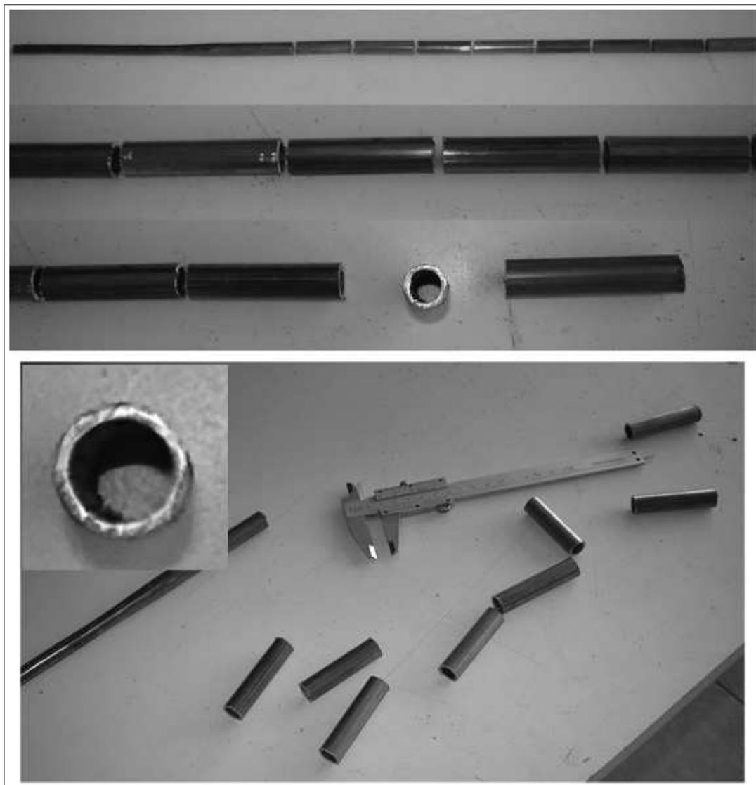
**Figura 3.17.** Medición de espesor final del tubo trefilado en laboratorio
