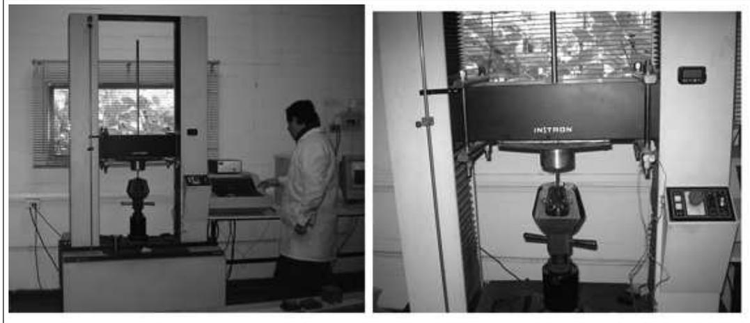
**Figura 3.8.** Máquina de tracción Instron, usada en el ensayo de trefilación
