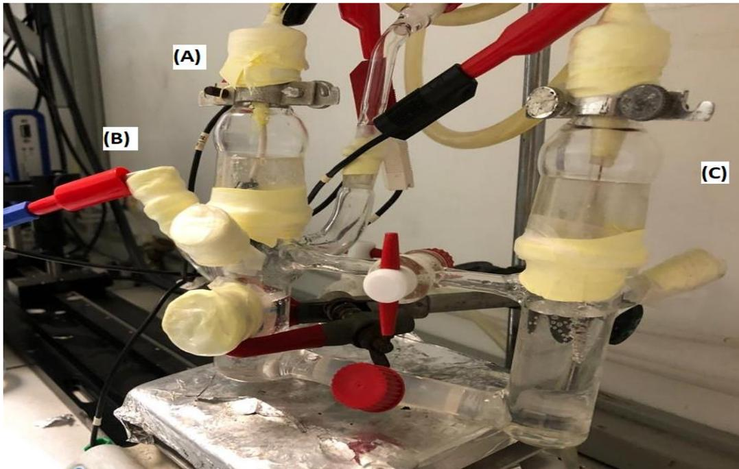
Figura 62: Celda electroquímica tipo H; donde a) Electrodo de trabajo; b) Electrodo de referencia y c) contra electrodo.
