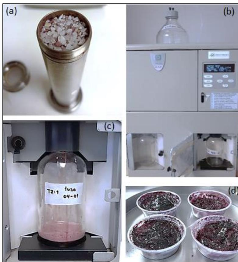
**Figura 5.** (a) Celda de extracción del ASE (b) Equipo ASE (c) Botella de recolección del extracto de coronta de maíz morado (*Zea Mays* L.) (d) Extracto liofilizado
